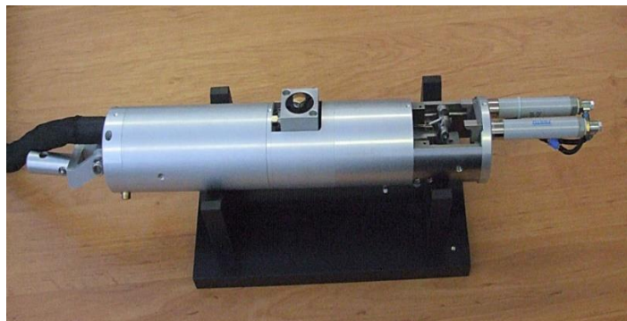
Obr. 5: Odberová hlavica zariadenia SSam™-2
