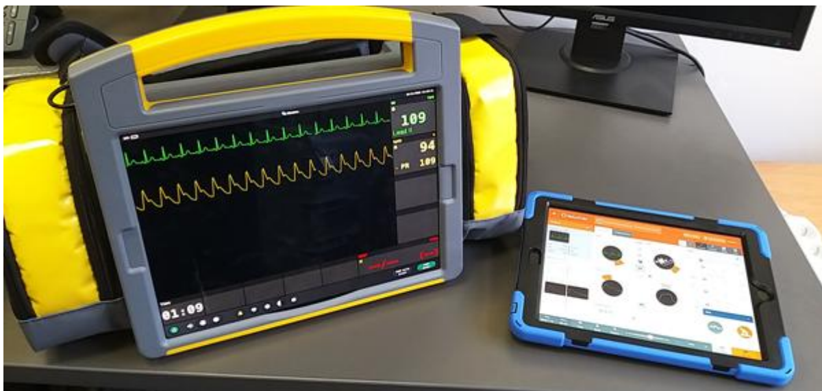
Obrázek 3 – Simulátor monitoru životních funkcí
