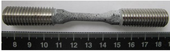
Obr. 2 Povrchová úprava zkušebního tělesa
