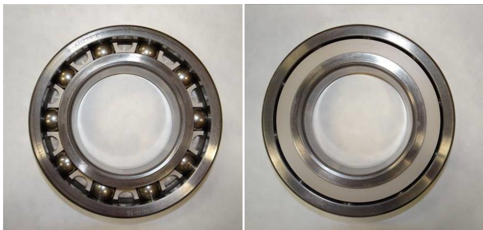
Obr. 3: Jednořadé radiální kuličkové ložisko, typ 6214, vnější Ø: 125 mm; pohled z přední (otevřené nalevo) a zadní (uzavřené napravo) strany klece.
