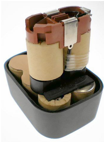
Obr. 4.4.2 Uspořádání bateriové sestavy
