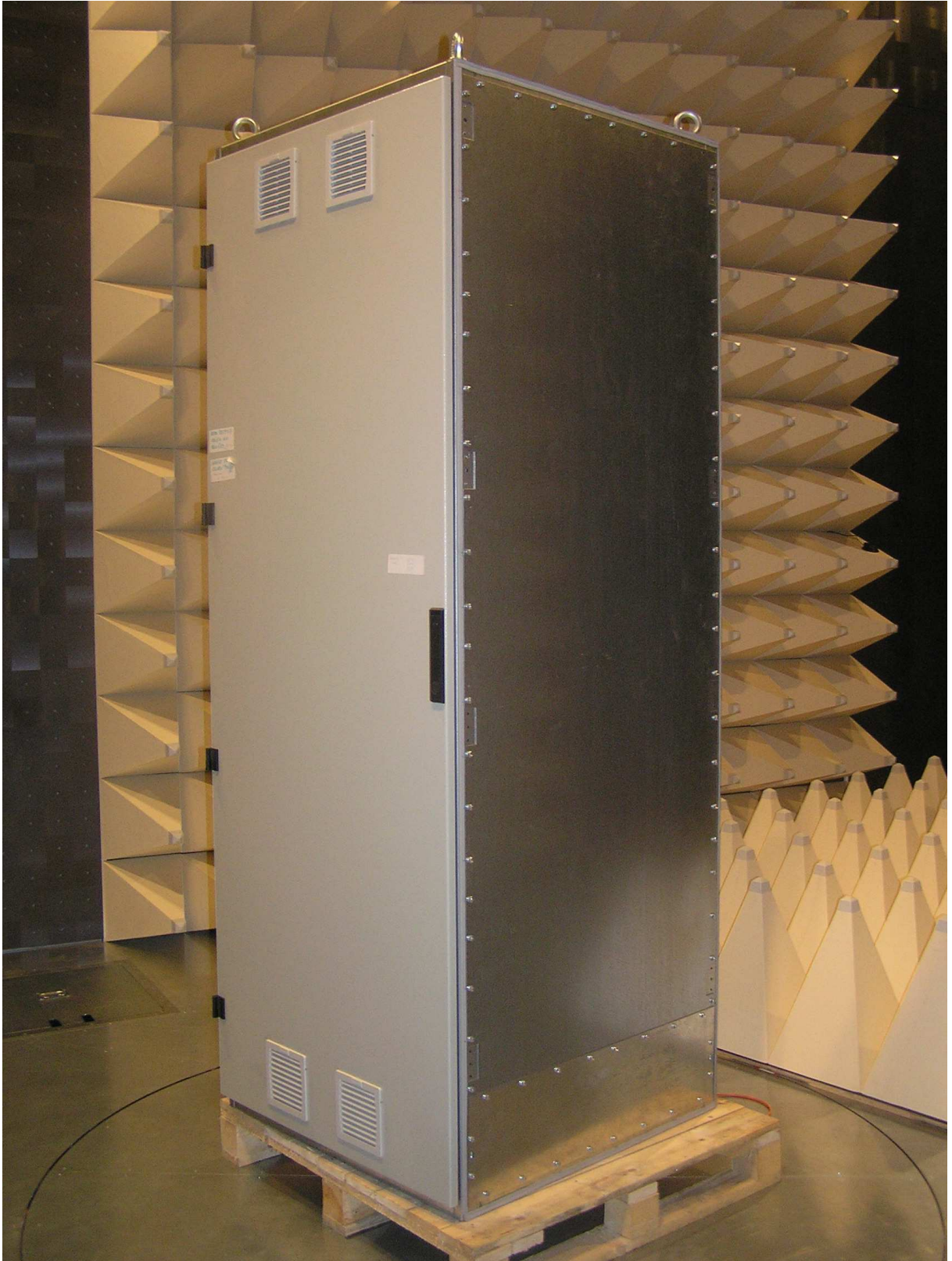
Obr. A.3: EMC verze rozváděče v bezodrazové komoře
