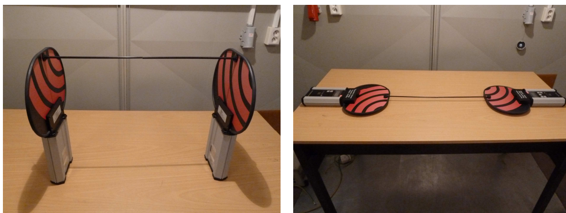
Obr. 3.3: Kalibrace podle normy IEEE STD-299 a MIL-STD-285
