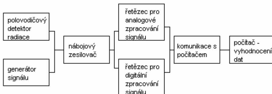
Obrázek 2.1.1 Blokové schéma konceptu obvodu
