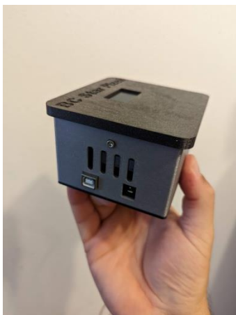
Obrázek 7 – Snímač úderu detail zdrojové krabičky (zdroj – vlastní)
