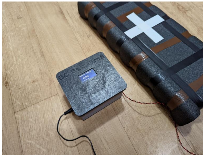
Obrázek 3 – Snímač síly úderu celkový pohled (zdroj – vlastní)
