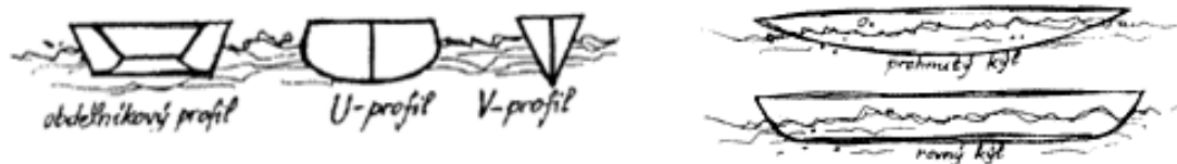
Obr. 5 – Příčný a podélný profil lodě
