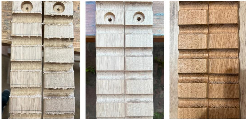
Obr. č. 55-57, Frézy-surové, obroušené, navoskované (archiv autora)
