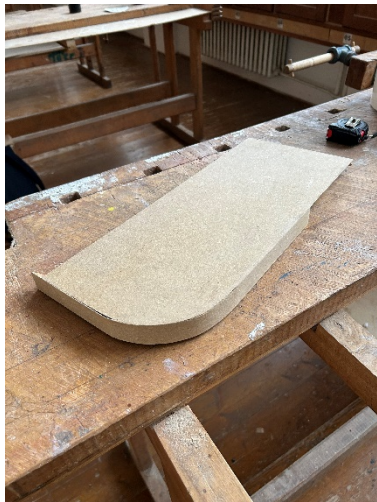
Obrázek 55-56 - zkouška ohybu MDF desky (archiv autora)
