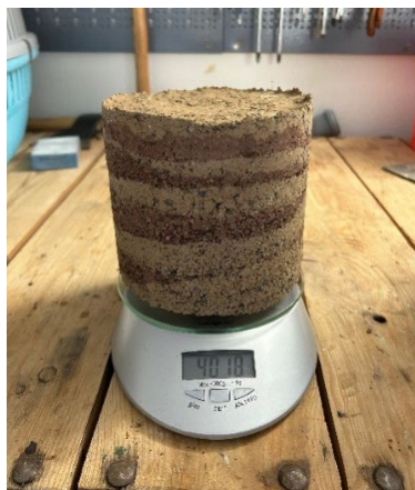
Obrázek 37 – váha hlíny, rozměr: průměr 145 mm, výška 135 mm (archiv autora)
