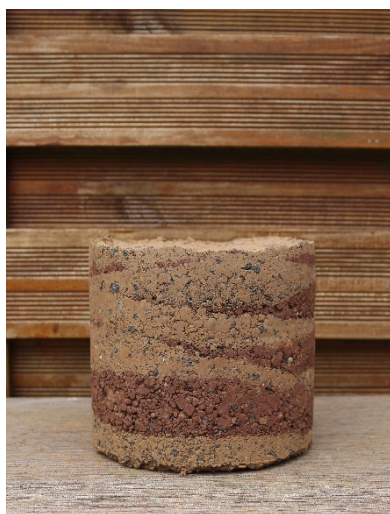
Obrázek 33-35 – zkoušky válců z dusané hlíny (archiv autora)
