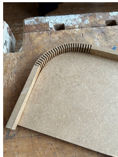
Obrázek 55-56 - zkouška ohybu MDF desky (archiv autora)
