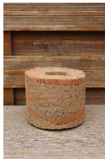
Obrázek 33-35 – zkoušky válců z dusané hlíny (archiv autora)
