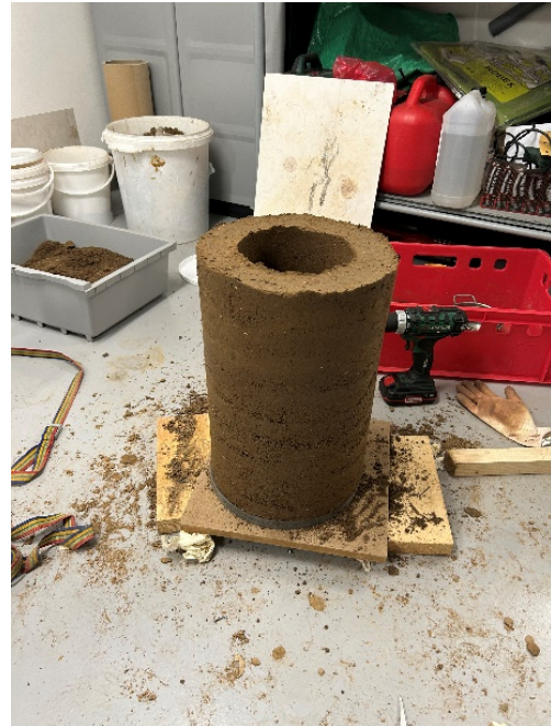
Obrázek 52 – nepovedený 1. pokus udusaného válce (archiv autora); Obrázek 53 – 2. pokus udusaného válce (archiv autora)
