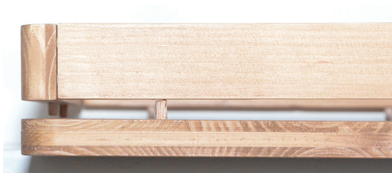
Obr. 30 - Konstrukční řešení, spojení kolíky (archiv autora)
