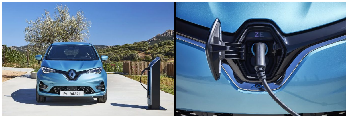
Obrázek č. 9: Kryt dobíjecího systému implementovaný v logu elektrického vozidla Renault Zoe
