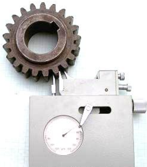
Obr. 22. Příklad pro kontrolu základní zubové rozteče [19]
