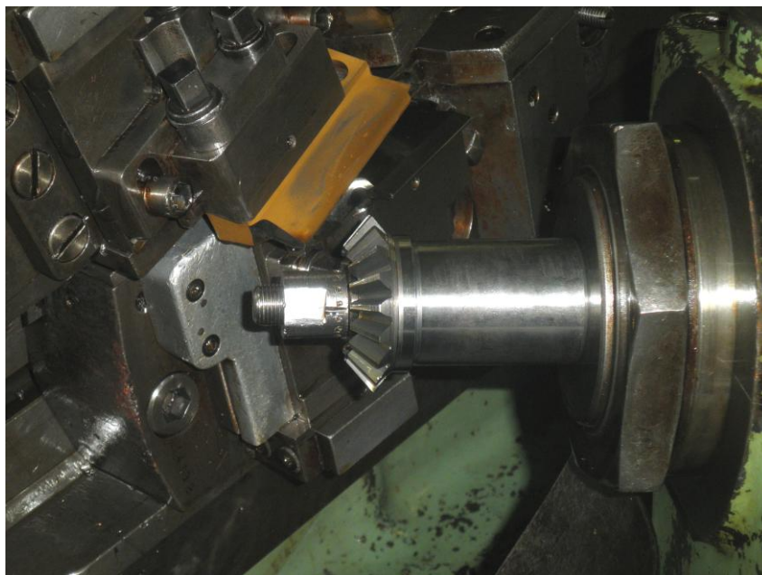
Obr. 34. Hoblování ozubených kuželových kol dvěma noži [22]
