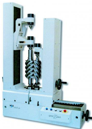
Obr. 25. Zařízení pro zkoušku jednobokým odvalem [21]
