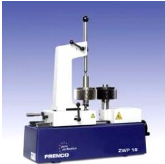
Obr. 26. Zařízení pro zkoušku dvoubokým odvalem [21]
