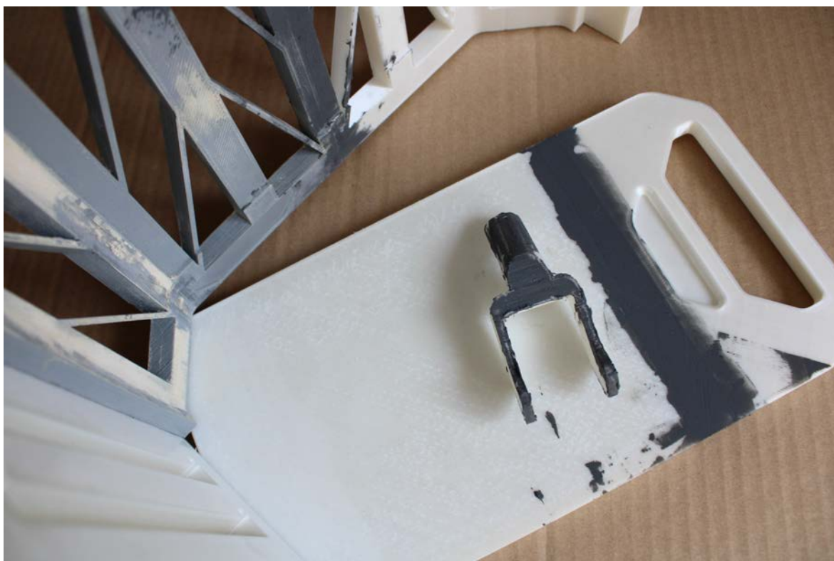
Obr. 19 některé díly zatmelené nebroušené
