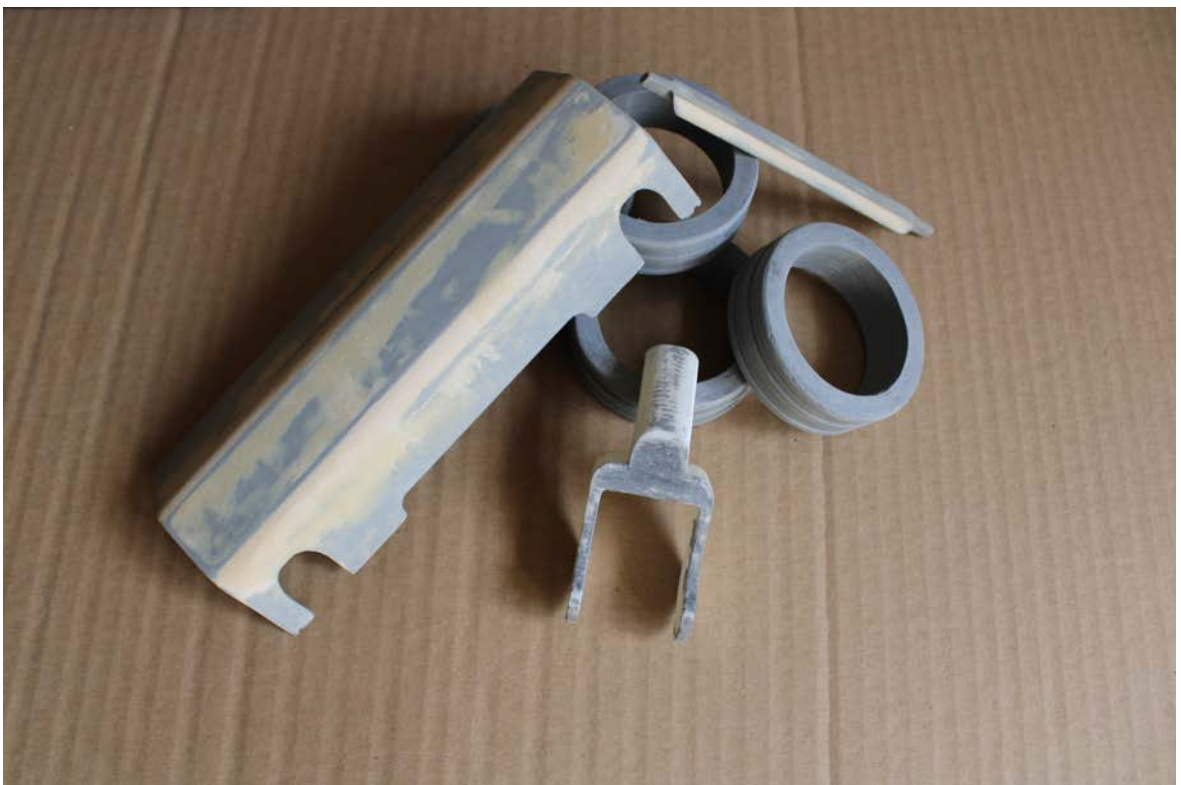
Obr. 18 část dílů po zatmelení a broušení
