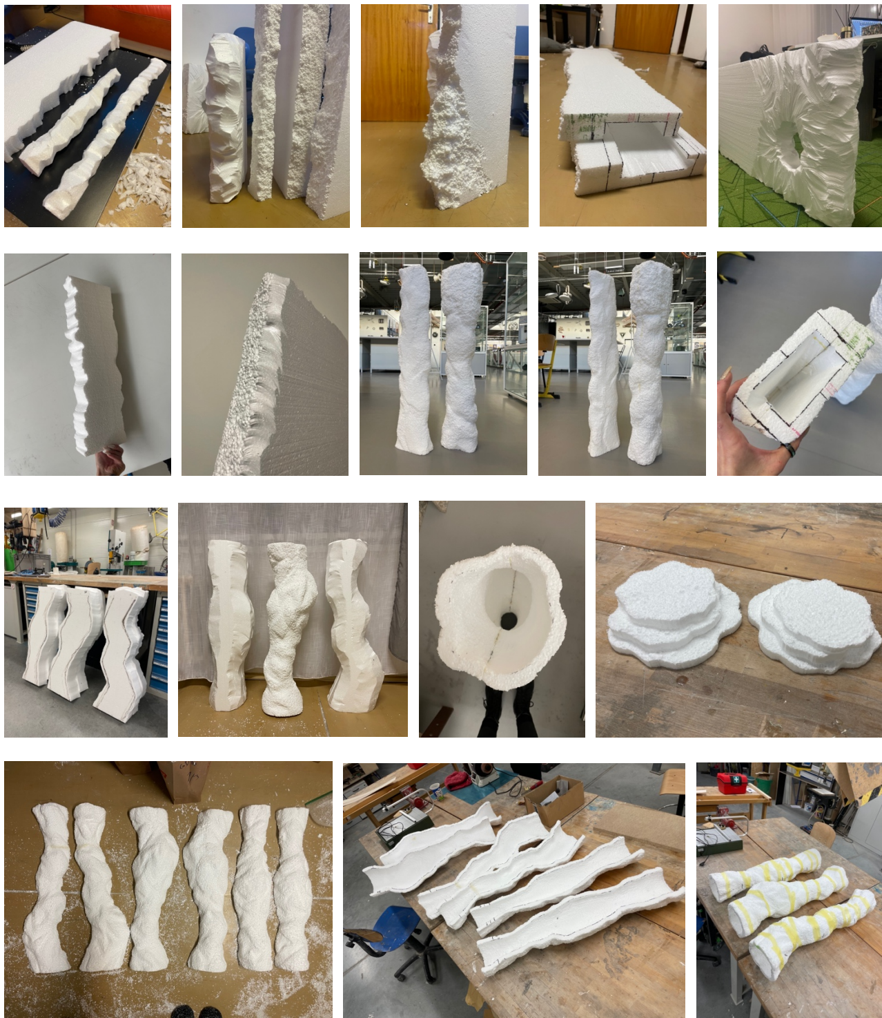
Archiv autora, výroba polystyrenových modelu-negativu, obrázek č. 47-63.
