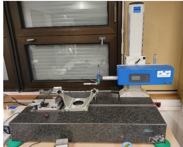
Obrázek 49 Drsnoměr HOMMEL ETAMIC T-8000
