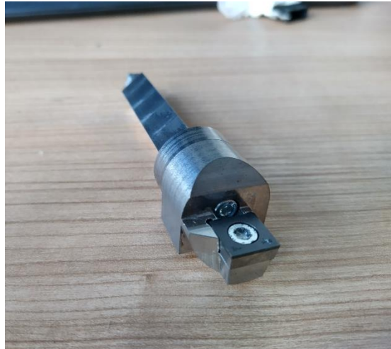
Obrázek 53 Držák VBD s hlavičkou s ploškou pro senzor AE
