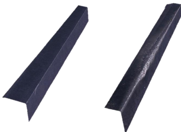
Obrázek 64 Porovnání nového (vlevo) a použitého (vpravo) břítu
