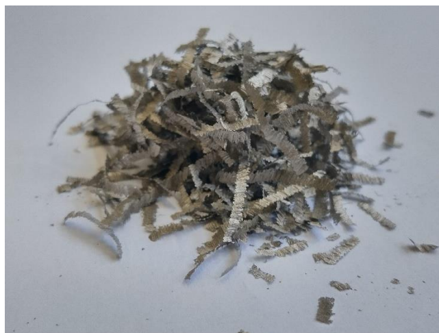
Obrázek 57 Tříška vzniklá při soustružení žárového nástřiku
