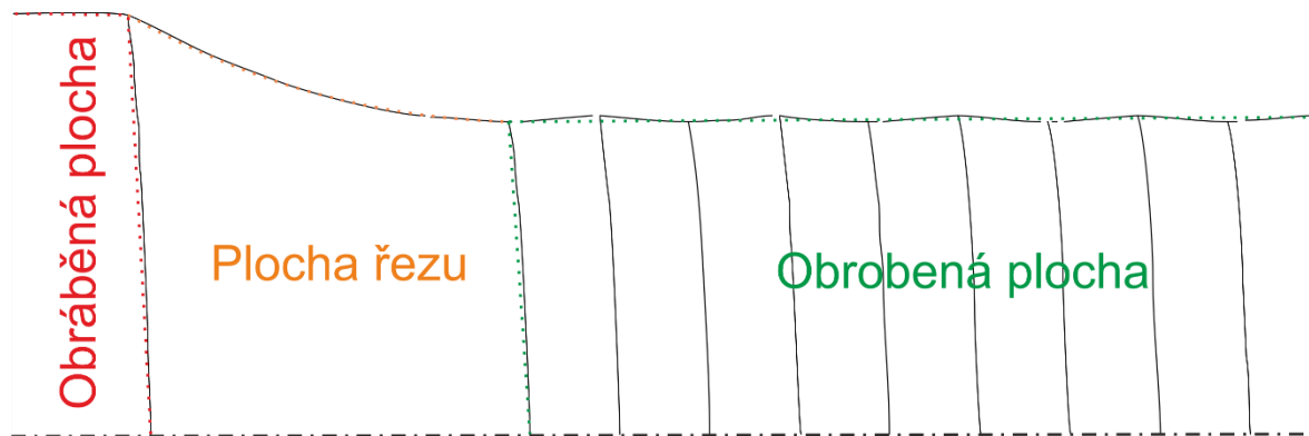
Obrázek 20 Teoretický obrobená plocha při \lambda_s = 50^\circ
