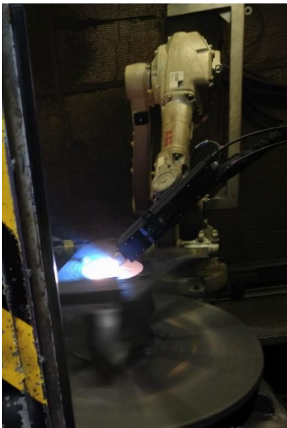
Obrázek 39 Stříkání elektrickým obloukem a manipulační robot
