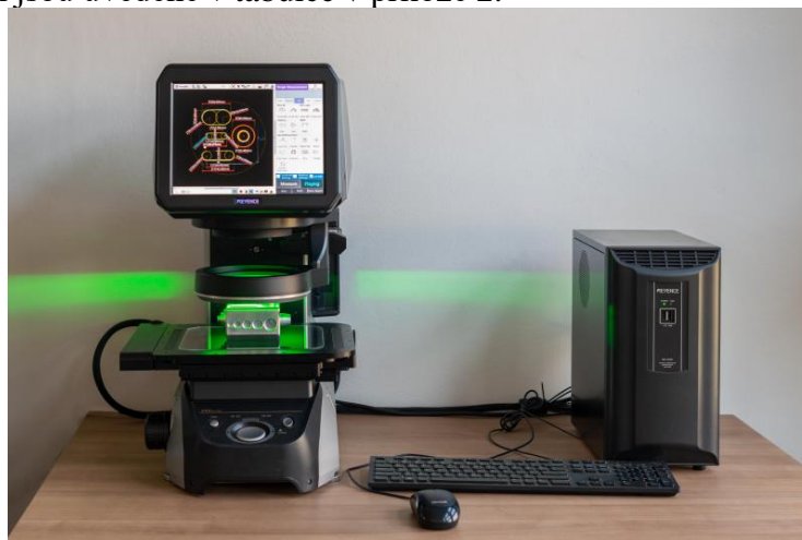
Obrázek 29 Profilprojektor KEYENCE IM7000 [48]
