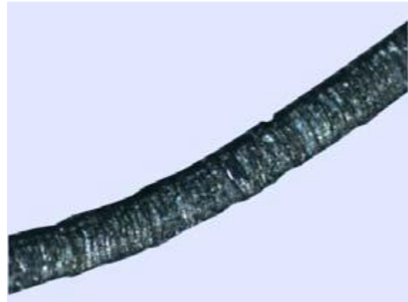
Obrázek 16 Tříska vzniklá při v_c=200 m/min [34]
