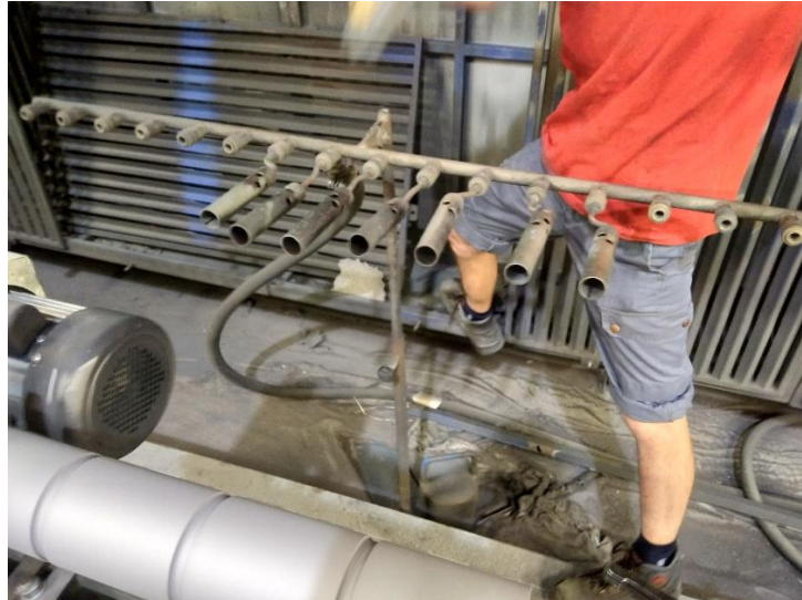
Obrázek 41 Trysky vzduchového chlazení
