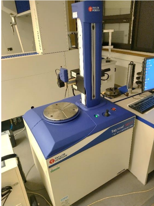
Obrázek 48 Kruhoměr TAYLOR HOBSON TALYROND 585LT
