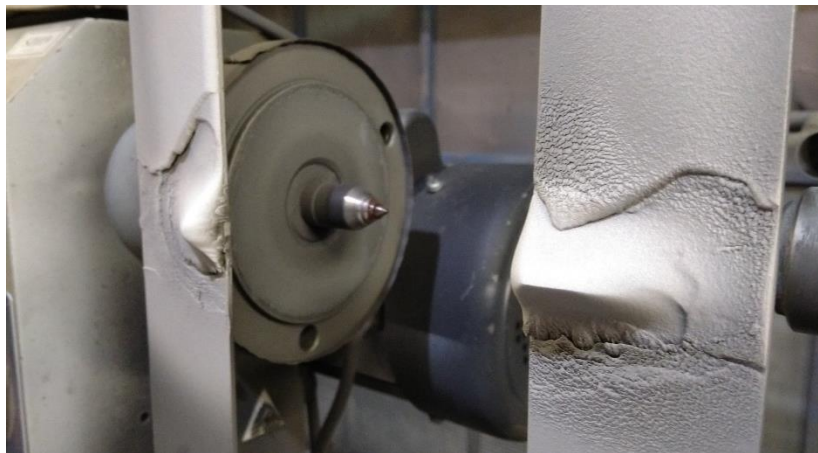
Obrázek 45 Stínící plechy s nánosem žárového nástřiku
