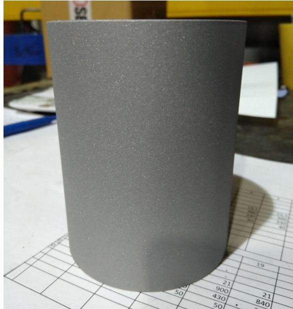
Obrázek 44 Otryskaný vzorek připravený pro nástřik
