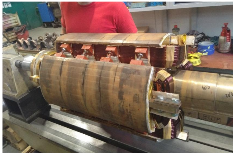
Obrázek 4 Rotor elektromotoru určený k žárovému stříkání opotřebovaných ploch pod ložiska
