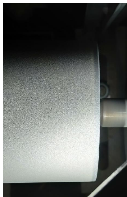
Obrázek 40 Nenastríkaný okraj válcové plochy vzniklý stíněním
