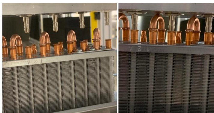
Obrázek 66 - Plnění dusíkem zkrácenými nástavci přípravku
