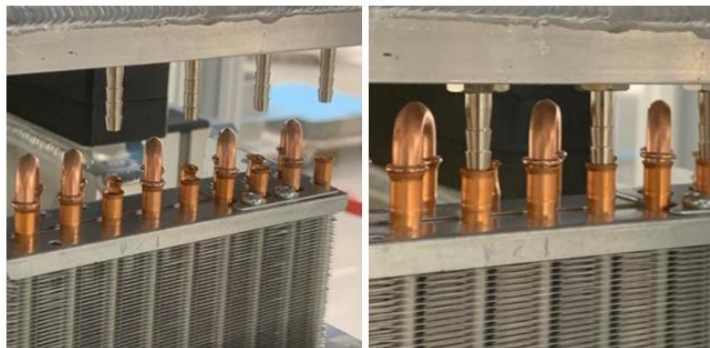
Obrázek 64 - Plnění dusíkem s dlouhými nástavci přípravku s menším hloubkou zájezdu
