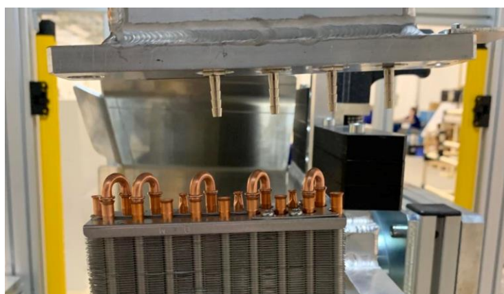
Obrázek 63 - Chybný nájezd plnění dusíkem
