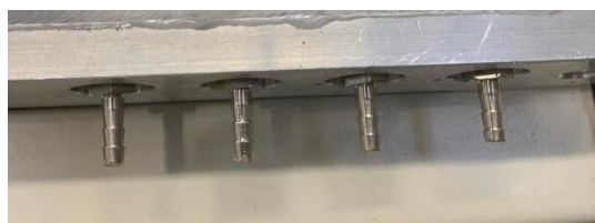
Obrázek 65 - Zkrácené nástavce přípravku pro plnění dusíkem
