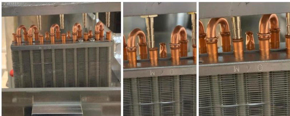
Obrázek 61 - Plnění dusíkem při vyšším vychýlení tepelného výměníku pomocí 3D Vision systému
