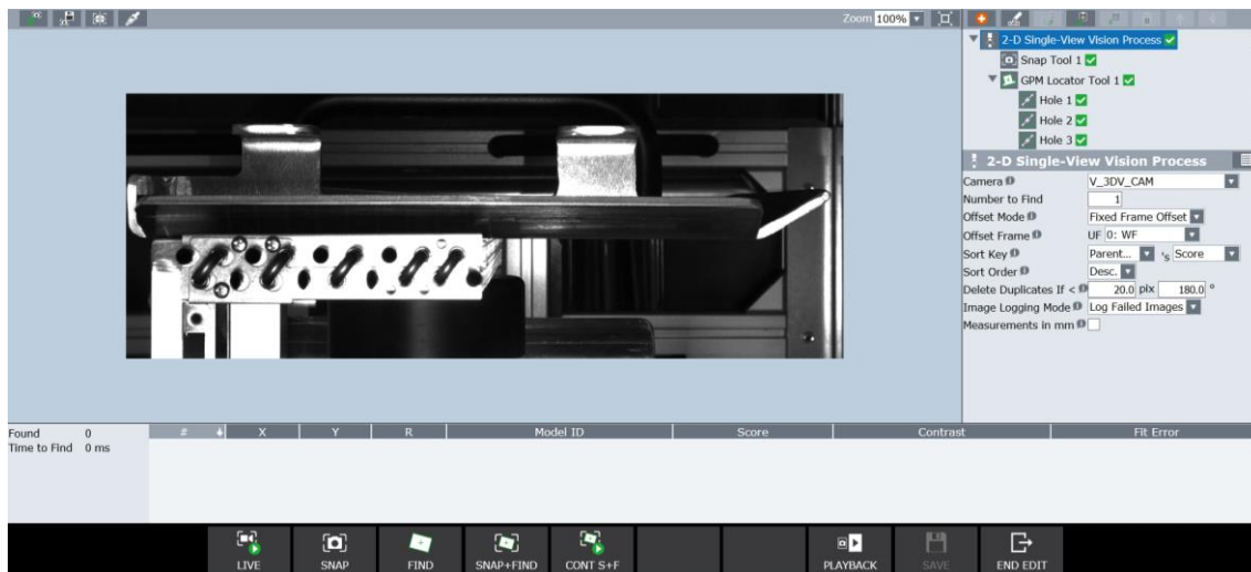
Obrázek 51 - 2D snímek kamery pro 2D kontrolu plnicí části výměníku
