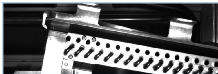
Obrázek 56 - Překročené vychýlení paletky při 2D kontrole
