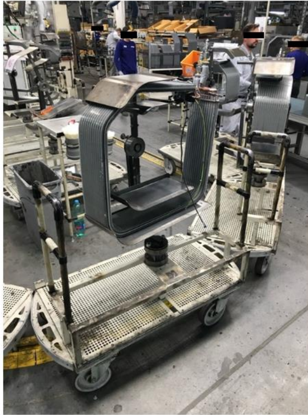
Obrázek 25 - Dopravování tepelného výměníku na pracoviště pro plnění dusíkem
