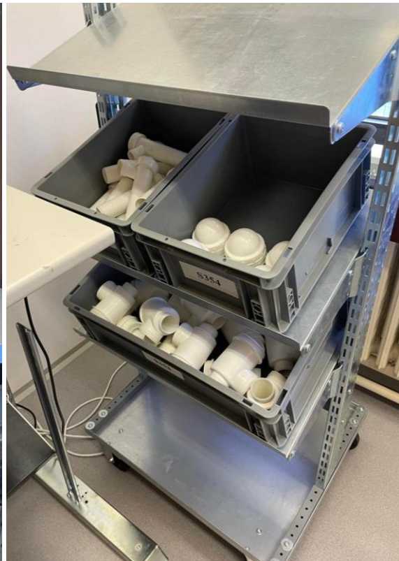
Obr. 10 Uspořádání součástek v regálu ergonomicky racionalizovaného pracoviště
