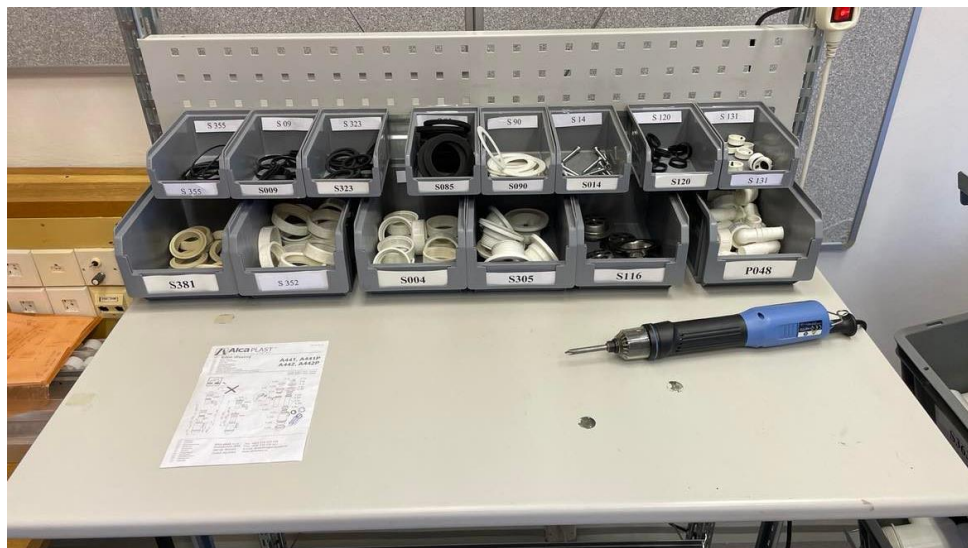
Obr. 11 Pracovní stůl s upořádáním součástek – ergonomická racionalizace
