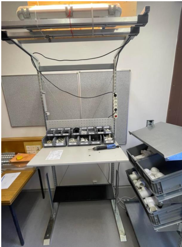
Obr. 9 Pohled na ergonomicky racionalizované pracoviště - varianta vestoje
