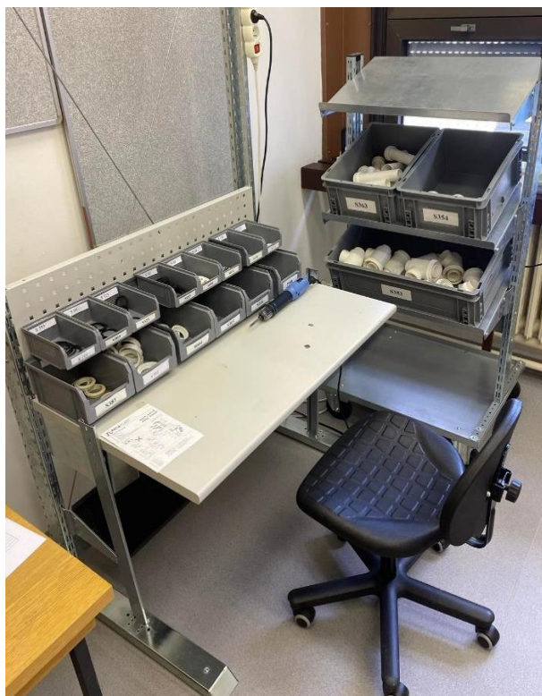
Obr. 12 Pohled na ergonomicky racionalizované pracoviště - varianta vsedě
