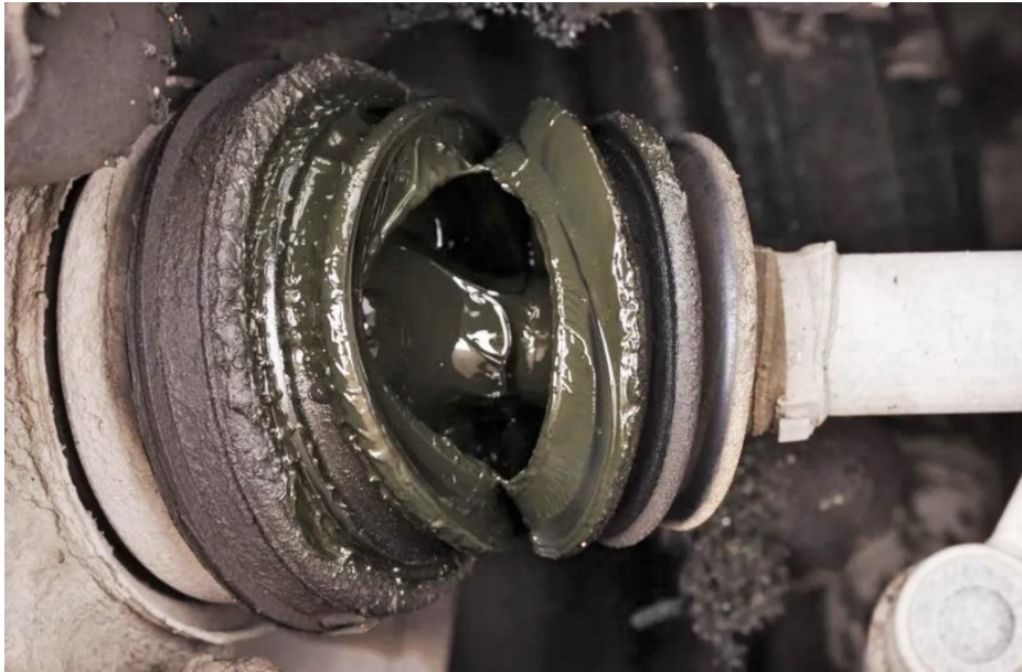
Obr. 23 Porušená prachovka kloubu s únikem maziva [15]
