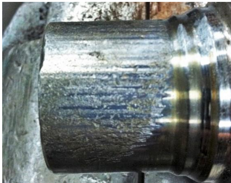
Obr. 19 Otěry a škrábance funkční plochy čepu kříže Hookova kloubu [14]
