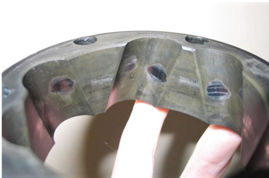
Obr. 22 Opotřebení na straně vnějšího kroužku homokinetického kloubu [16]
