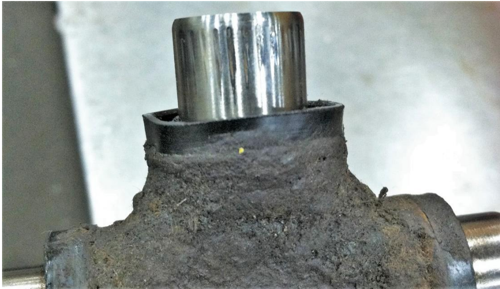
Obr. 20 Odlupování funkční plochy čepu kříže Hookova kloubu [14]
