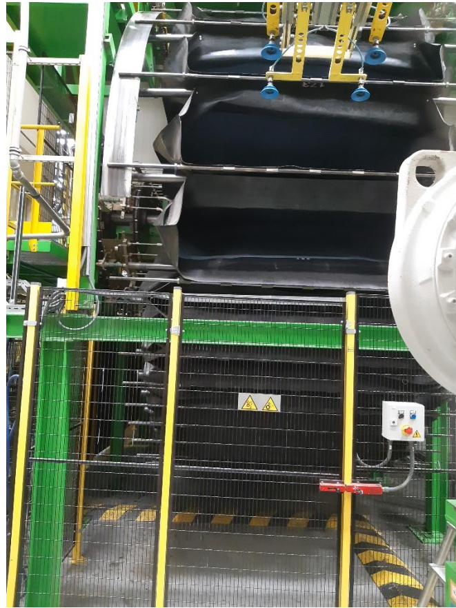
Obrázek 11 Stroj využívající vakuovacích vaků k laminaci
