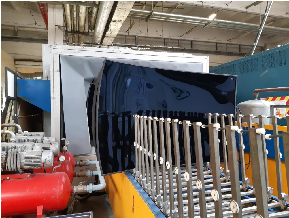
Obrázek 10 Foto stroje využívající vakuovací hadice (po obvodu skla)
