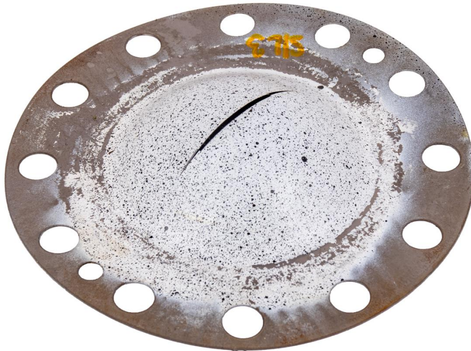
Obrázek 38 - Porušený vzorek pro bulge test
