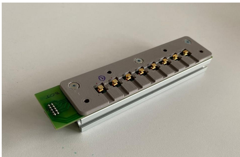
Obr. 29 Konstrukce horního dílu dynamických nebo statických čelistí.
