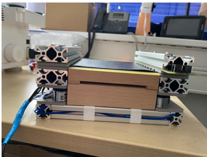
Obr. 27 Upnutí testovacího vzorku do přípravku.
