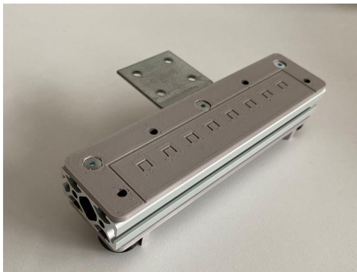
Obr. 24 Konstrukce dolního dílu dynamických nebo statických čelistí.
