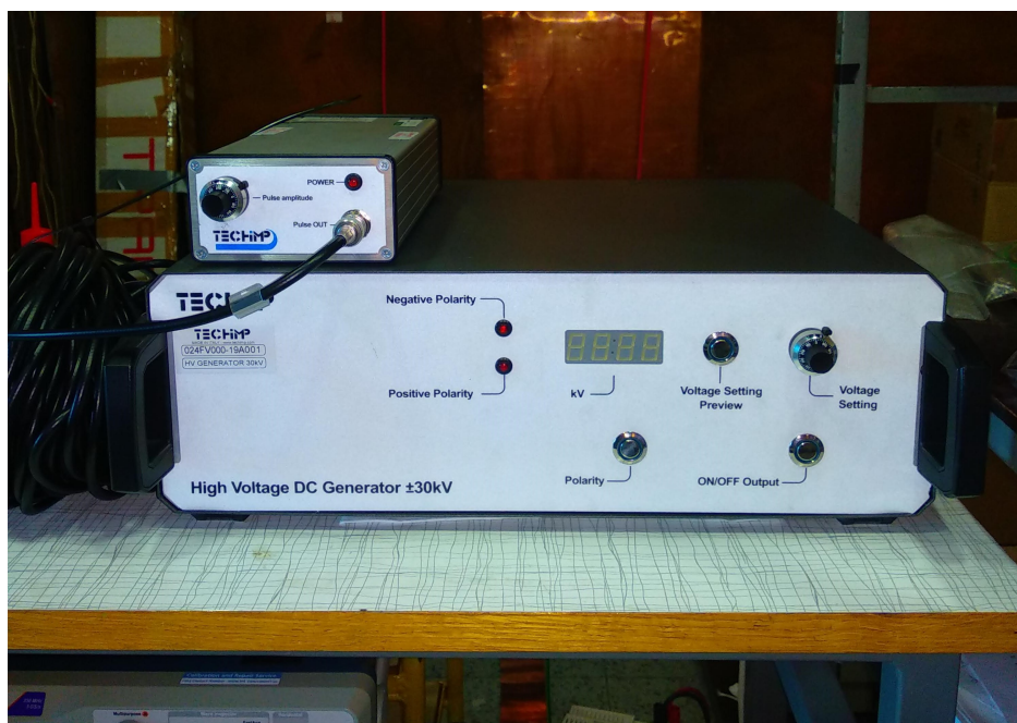
Obrázek B6: Zdroje elektrického napětí, větší - DC zdroj, menší na DC zdroji - zdroj pulzního napětí, zezadu
