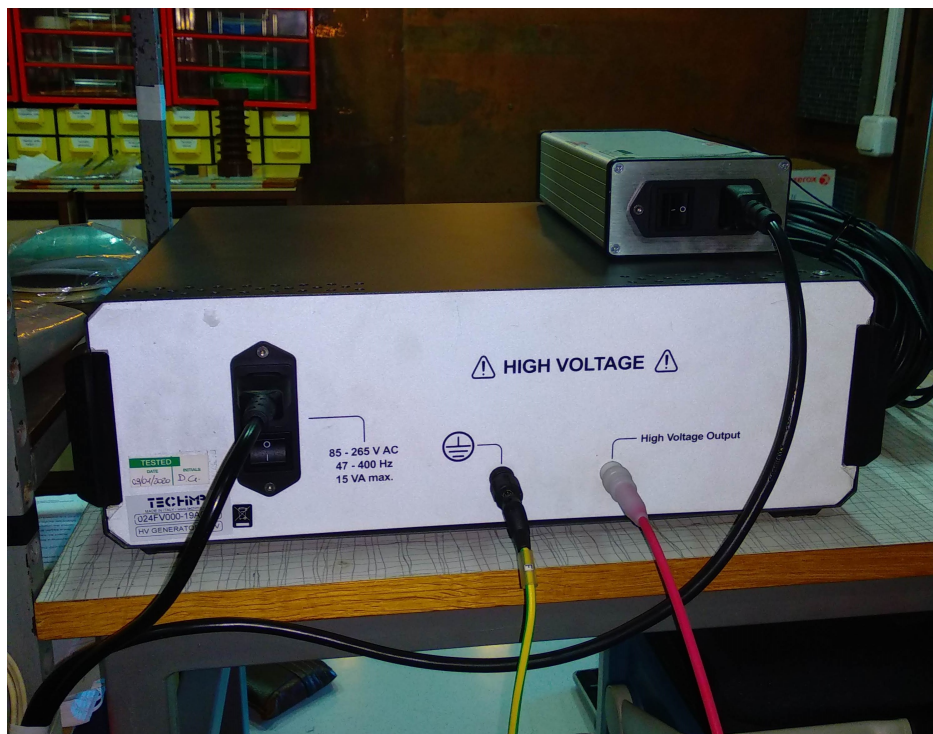
Obrázek B5: Zdroje elektrického napětí, větší - DC zdroj, menší na DC zdroji - zdroj pulzního napětí, zepředu
