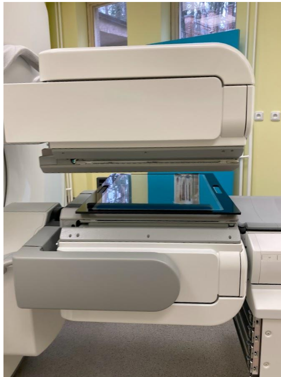
Obrázek 2: Umístění plošného zdroje pro denní test homogenity SPECT
