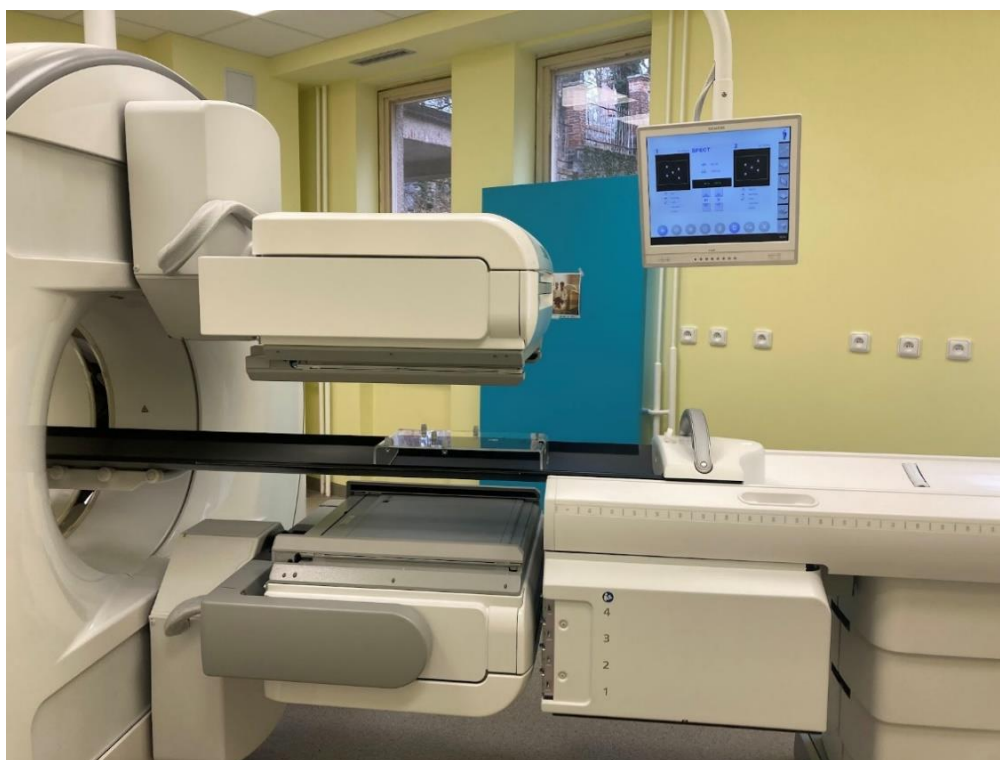
Obrázek 9: Umístění zdrojů při testu prostorové registrace detektorů
