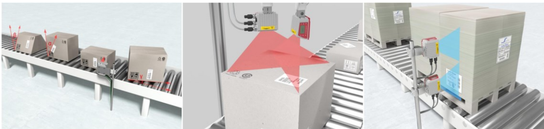
Obr. 16 Znáznornění chybného vyčítání z důvodu špatné orientace čárového kódu
