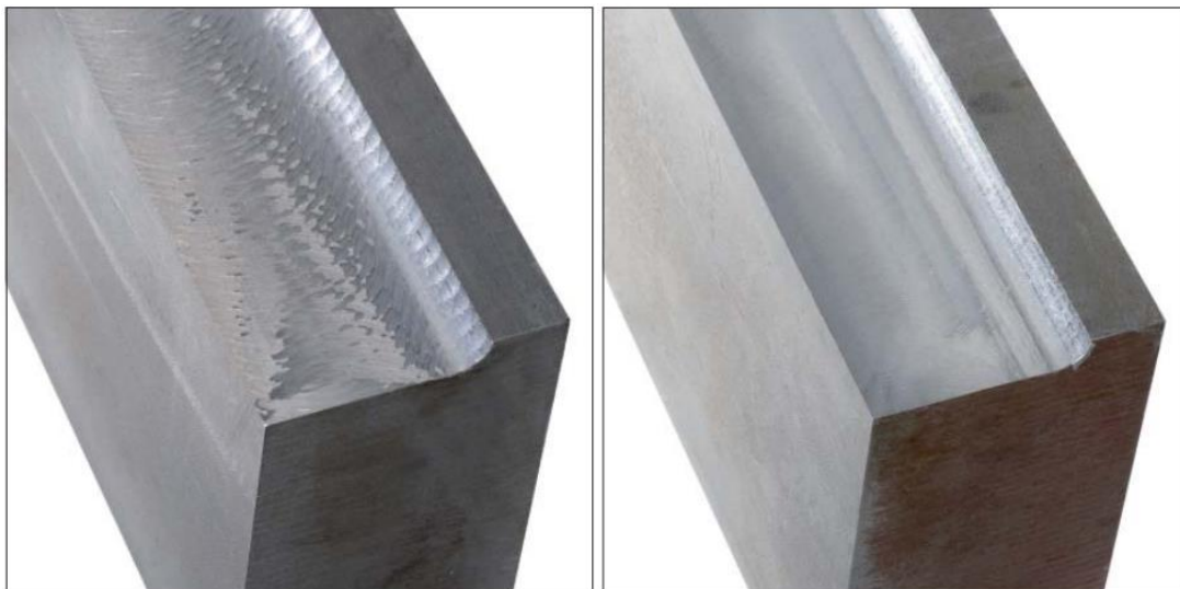
Obr. 1: Frézování bez zapnuté funkce ACC (vlevo), frézování se zapnutou funkcí ACC (vpravo) [8]
