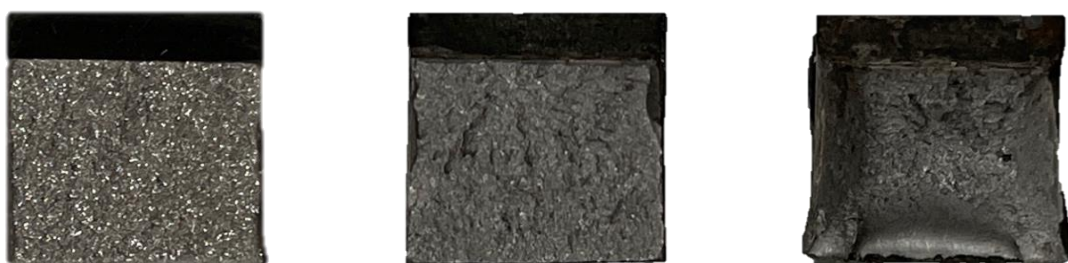
Obrázek 21: Vzorky po zkoušce rázem v ohybu metodou Charpy – teplotně cyklovaný vzorek (vlevo), teplotně cyklovaný vzorek 1050 °C (uprostřed) a teplotně cyklovaný vzorek 1050 °C + P (vpravo)
