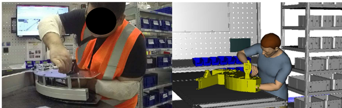
Obrázek 6-29: CL11 – Poloha č. 1 – Utažení šroubku pomocí klíče a ráčny [autor]
