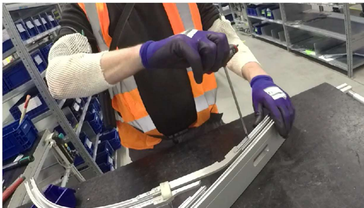
Obrázek 7-4: Kritická poloha při utažení šroubů [autor]
