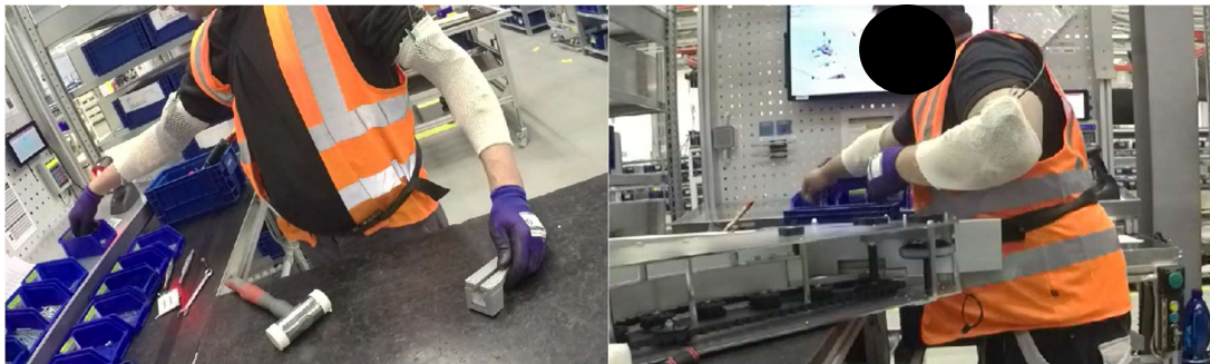
Obrázek 7-2: Kritická poloha při výběru ze zásobníku [autor]
