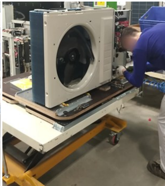
Obr. 9-1: Pozice montáže spodní části
