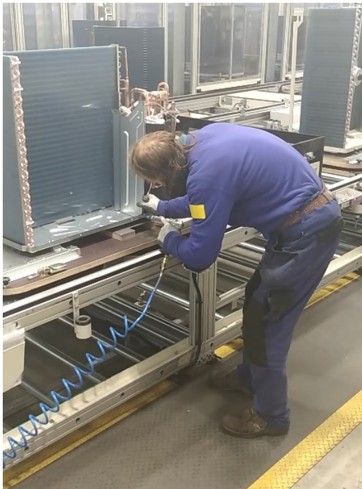
Obr. 10-73: Pozice montáže ochranného plechu
