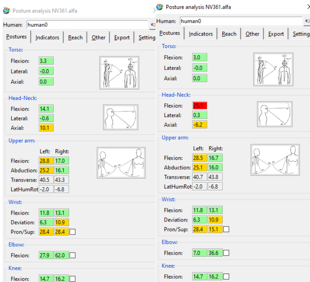
Obrázek 6.20: Metoda NV 361 šesté pozice pro 5. percentil (vlevo) a 95. percentil (vpravo)
