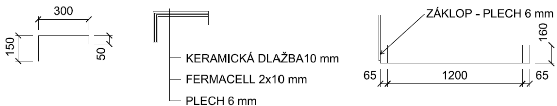
Obr. 14 – Provedení schodišťových stupňů a řez schodišťovým ramenem
