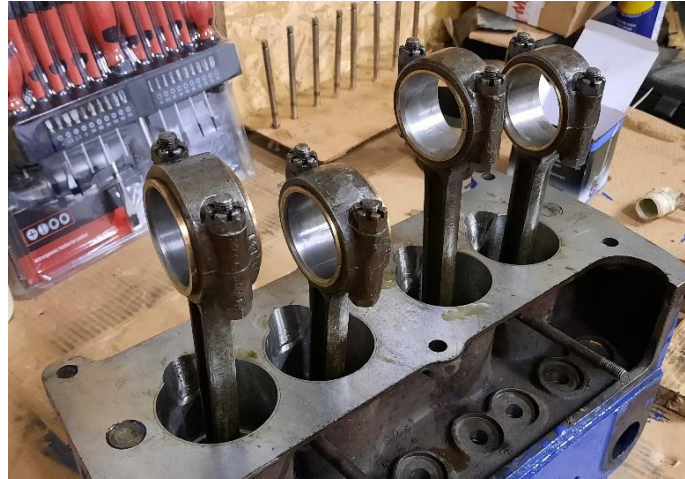
Obr. 65: Ložiska z olověné kompozice SV motoru Praga Piccolo
