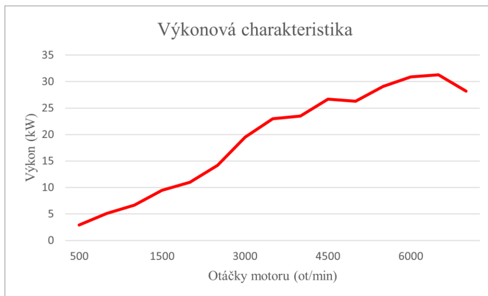
Obr. 32: Výkonová charakteristika jednoválcového motoru
