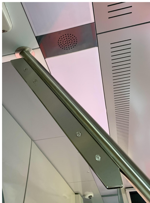
Obr. 2-7: Ukázka nepohledových nosných a kotevních prvků (foto autor)
