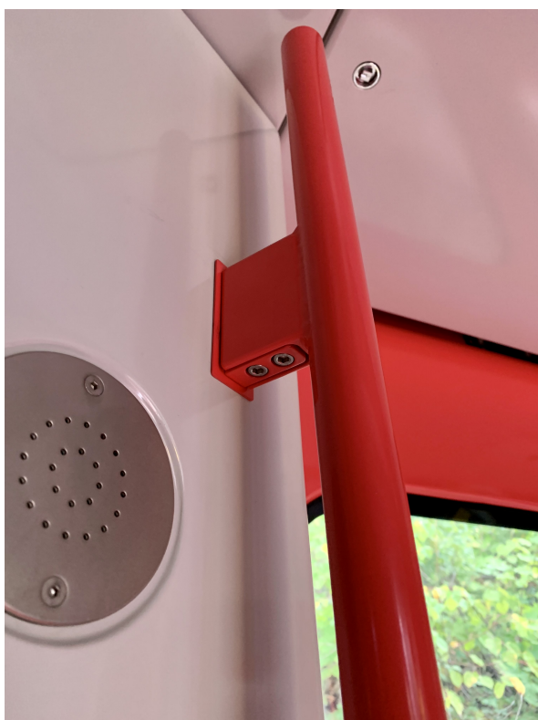
Obr. 2-6: Ukázka pohledových nosných a kotevních prvků (foto autor)
