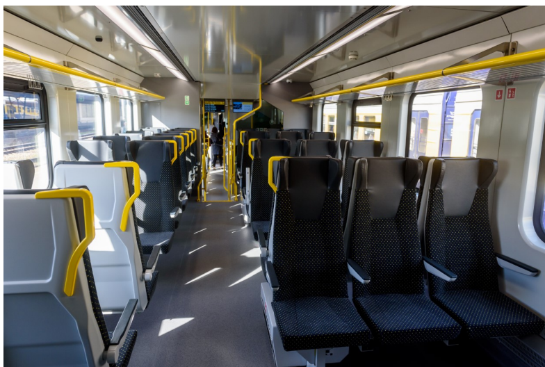
Obr. 2-4: Ukázka barevné kompozice interiéru s ocelovými madly [6]
