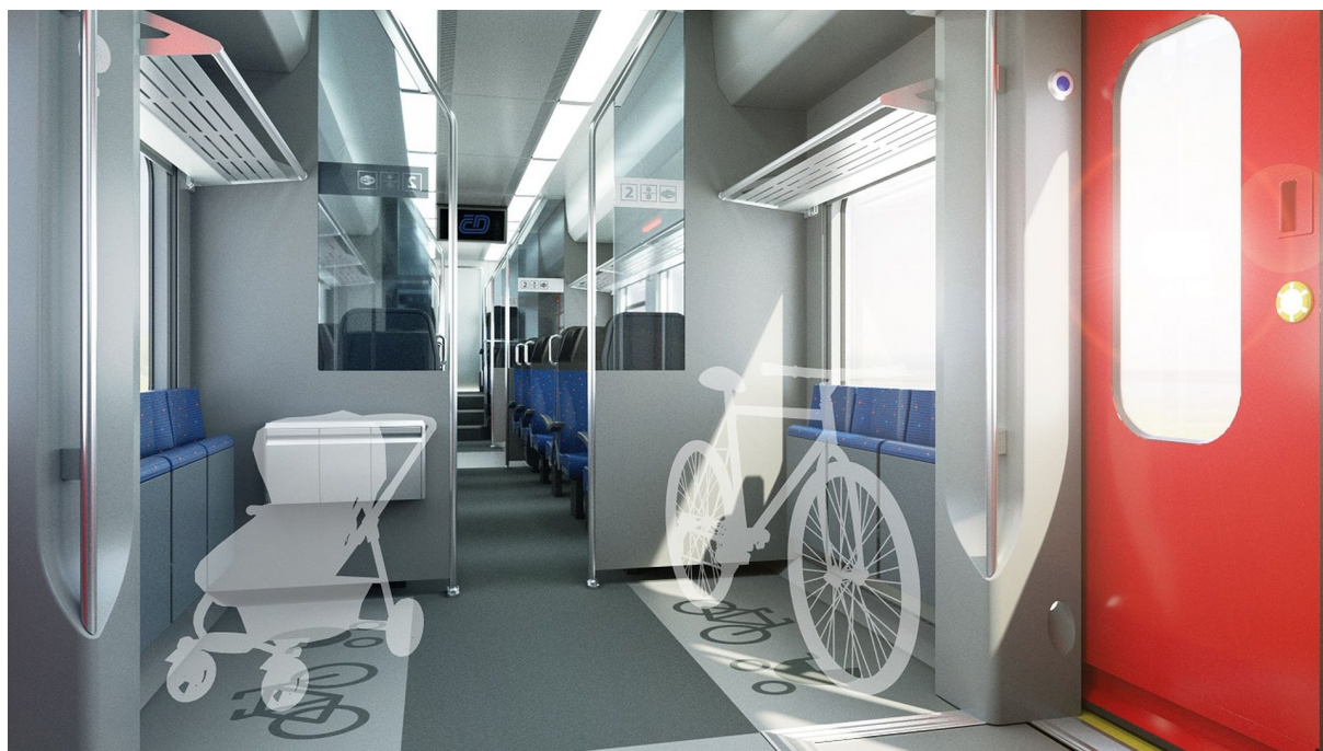
Obr. 3-3: Uspořádání interiéru elektrické jednotky Škoda RegioPanter 20Ev [35]
