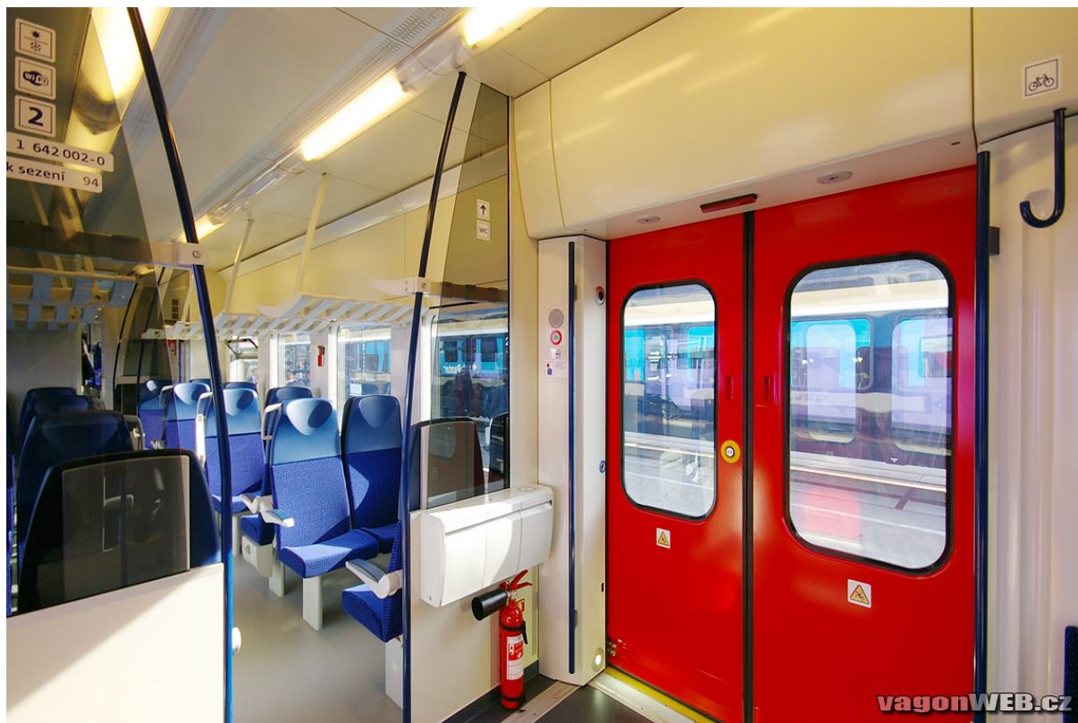
Obr. 2-12: Ukázka zástěny oddělující nástupní prostor od prostoru pro cestující [10]
