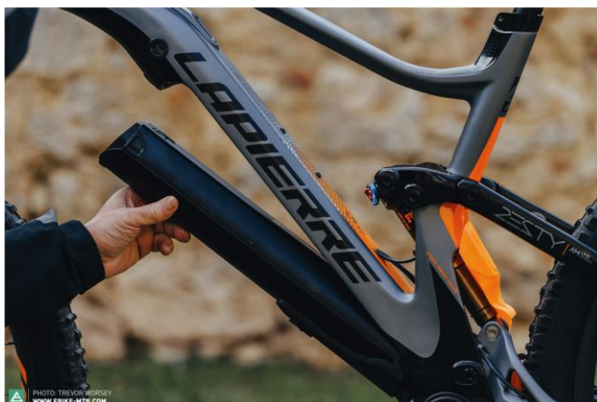
Obrázek 4 – uložení akumulátoru nad motorem ve středu rámu [14]
