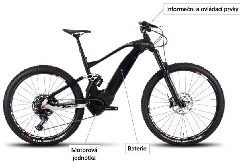
Obrázek 2 – základní schéma prvků pohonu e-MTB [6]
