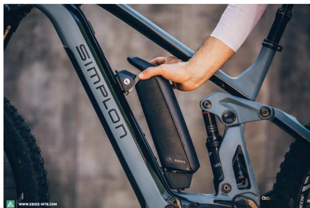
Obrázek 5 – uložení přídatného akumulátoru na rámu (primární akumulátor je uložen uvnitř trubky rámu) [14]
