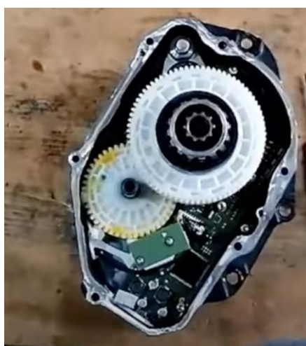
Obrázek 7 – Převodové soukolí Bosch CX [21]
