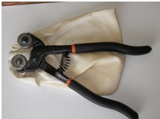
Obr. č. 21. Mozaikové lámací kleště Fotodokumentace Veronika Hrbáčková
