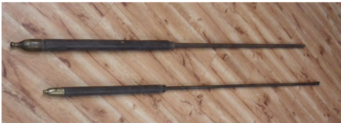
Obr. č. 7. Sklářské píšťaly, složené z kovové hlavně, u ústí rozšířené, dřevěného válcovitého držadla a náústku ze žlutého kovu.
