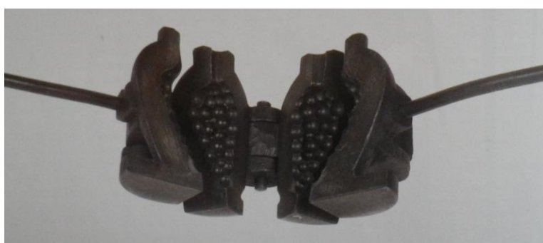
Obr. č. 8. Třídílná kovová forma na láhev v podobě hroznu. LNĚNIČKOVÁ, J.: Obalové sklo , 2007, str. 40
