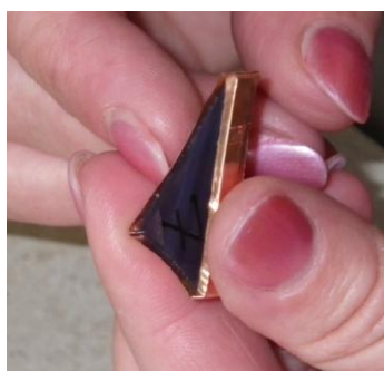
Obr. č. 33. Ohýbání přesahů pásky
