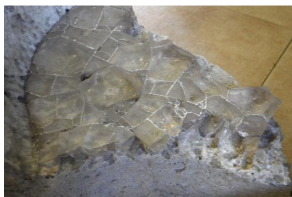
Obr. č. 12.: Část tavicí pánve obsahující na dně zbytek skloviny. Depozitář muzea v Blovicích
