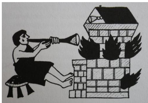
Obr. č. 1.: Pec s vertikálním technologickým uspořádáním. DRAHOTOVÁ, O.: Historie sklářské výroby v českých zemích I. díl. , 2005, str. 466
