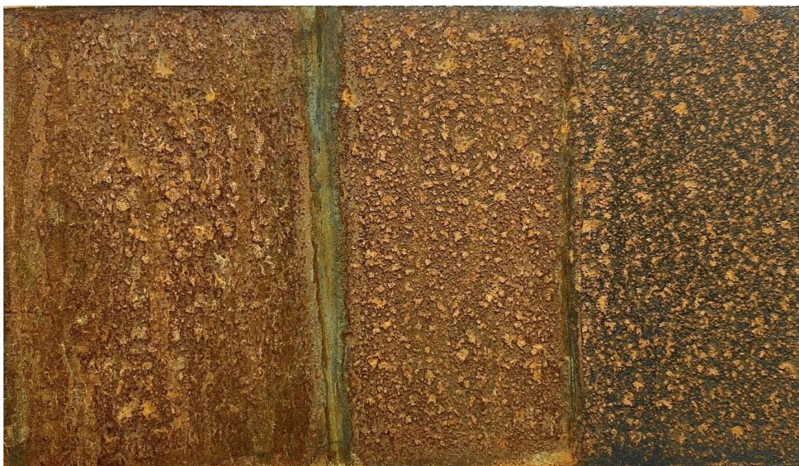
Obr. 87: Vzorek č. 41 s nátěrem HCA-C v několika vrstvách po zkoušce NSS, expozice 4 hod Zdroj: (autor, 2023)
