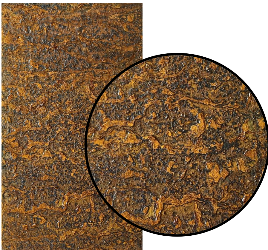
Obr. 81: Vzorek č. 34 včetně zvětšení po zkoušce NSS, expozice 48 hod
