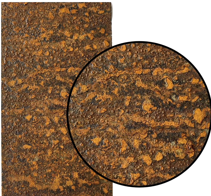
Obr. 80: Vzorek č. 33 včetně zvětšení po zkoušce NSS, expozice 48 hod
