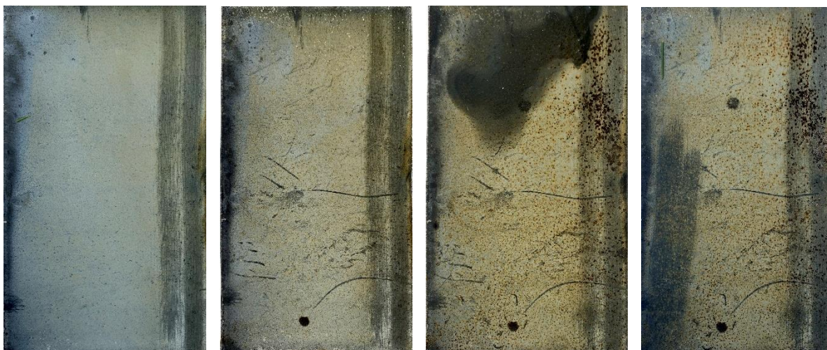
Obr. 64: Vzorek č. 20 po jednotlivých časových intervalech, tj. po 24, 60, 84 a 108 hodinách expozice Zdroj: (autor, 2023)
