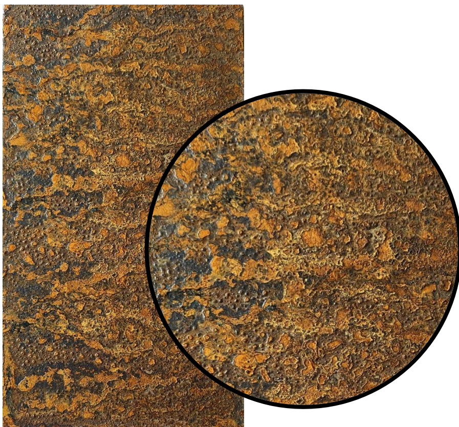
Obr. 78: Vzorek č. 31 včetně zvětšení po zkoušce NSS, expozice 48 hod
