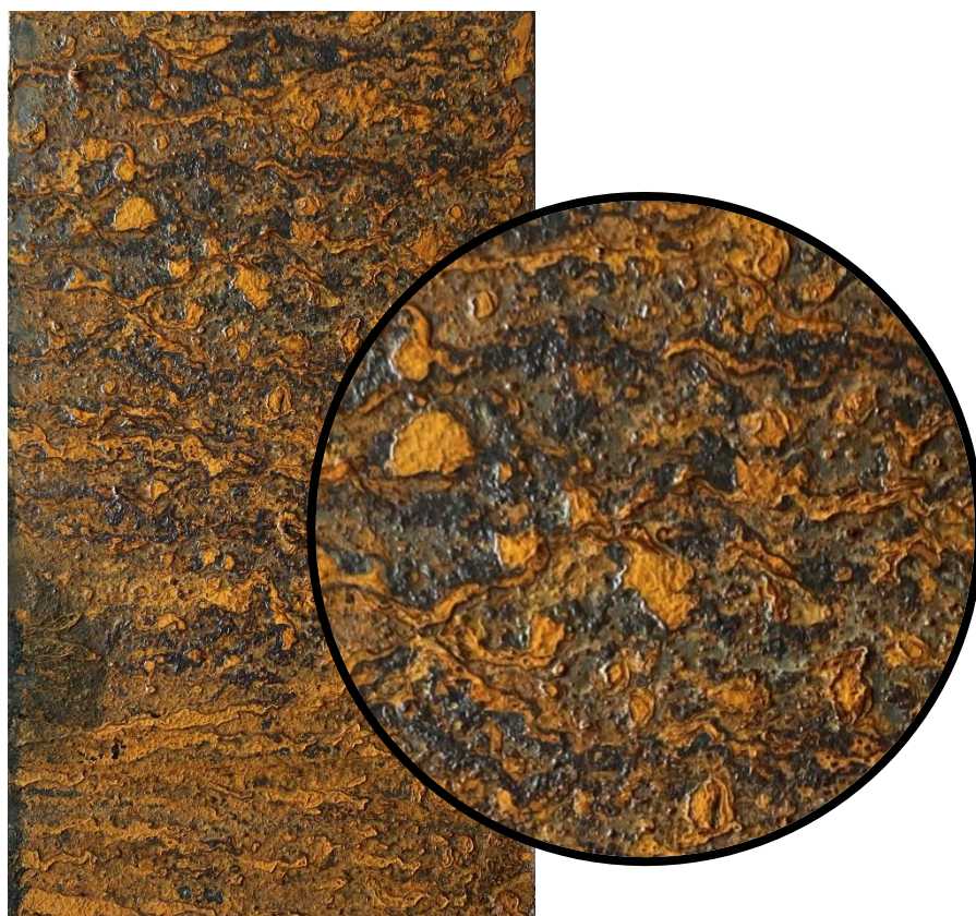
Obr. 73: Vzorek č. 26 včetně zvětšení po zkoušce NSS, expozice 48 hod
