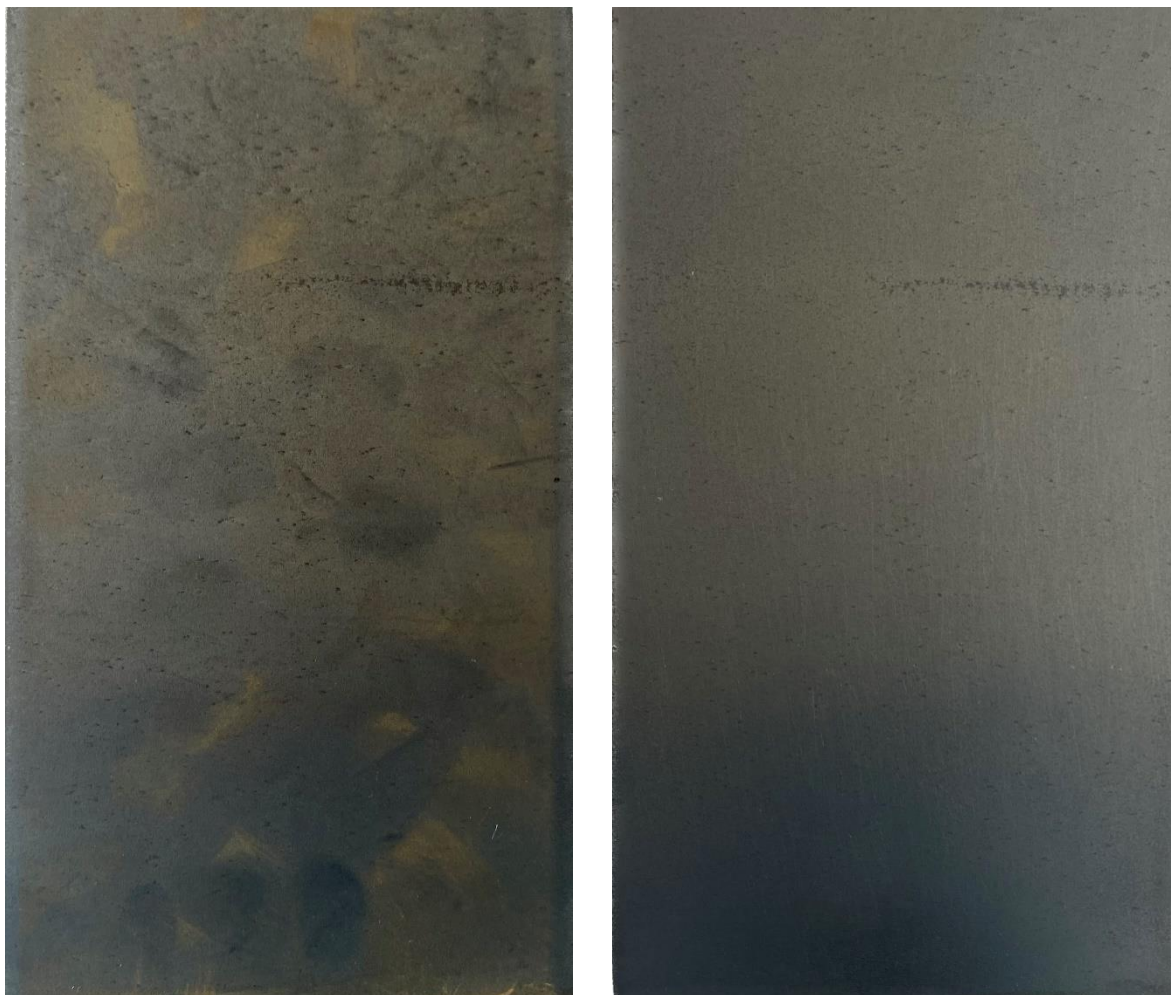
Obr. 32: Vzhled vzorku č. 19 před a po základní přípravě povrchu
