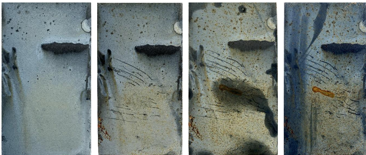
Obr. 63: Vzorek č. 19 po jednotlivých časových intervalech, tj. po 24, 60, 84 a 108 hodinách expozice Zdroj: (autor, 2023)
