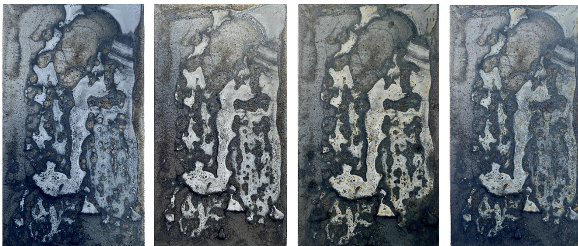
Obr. 66: Vzorek č. 22 po jednotlivých časových intervalech, tj. po 24, 60, 84 a 108 hodinách expozice Zdroj: (autor, 2023)
