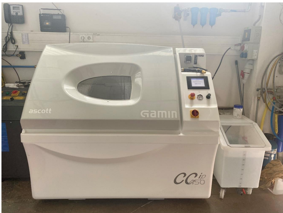
Obr. 46: Cyklická korozní komora Ascott o objemu 450 l s nádobou na solný roztok Zdroj: (autor, 2023)
