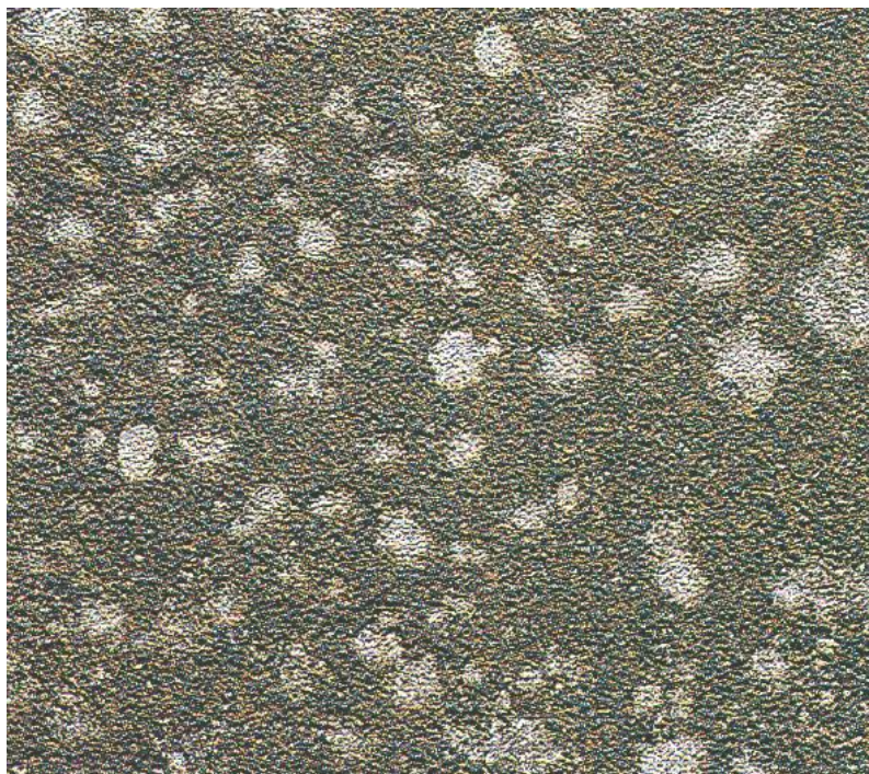
Obr. 24: Lehký stupeň bleskové koroze – L
