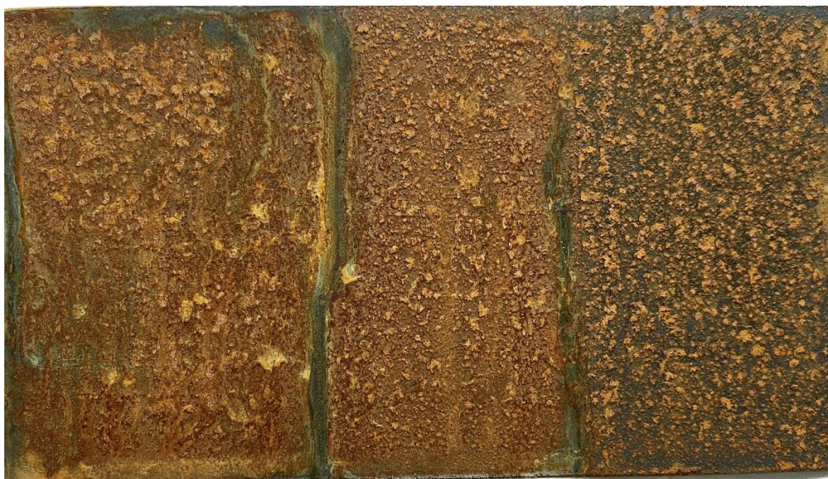
Obr. 85: Vzorek č. 39 s nátěrem HCA-C v několika vrstvách po zkoušce NSS, expozice 4 hod Zdroj: (autor, 2023)
