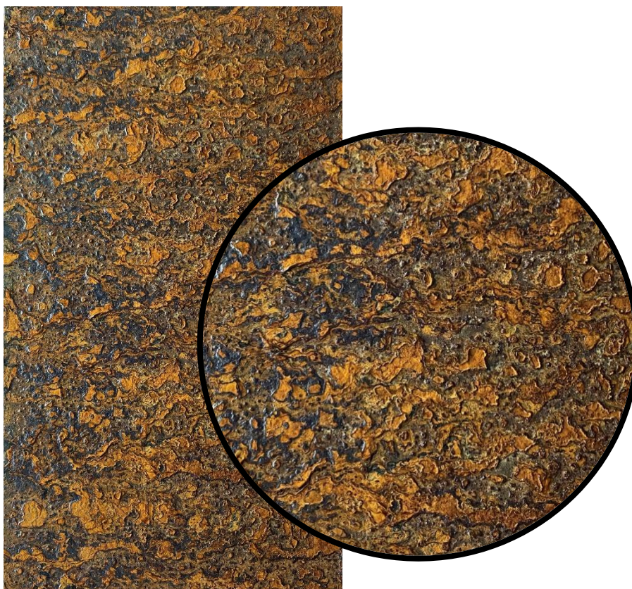
Obr. 75: Vzorek č. 28 včetně zvětšení po zkoušce NSS, expozice 48 hod
