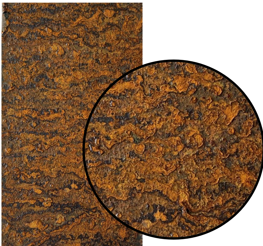
Obr. 72: Vzorek č. 25 včetně zvětšení po zkoušce NSS, expozice 48 hod
