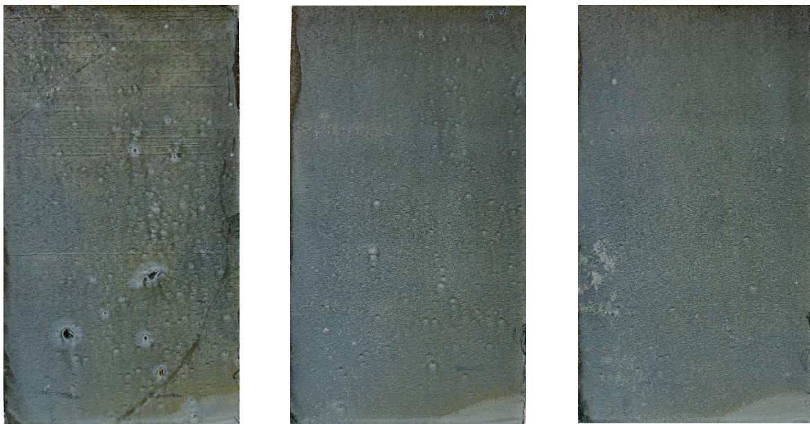
Obr. 35: Vzorky č. 28, 29 a 30 ošetřeny nízkotlakým stříkáním umístěny do korozní komory Zdroj: (autor, 2023)
