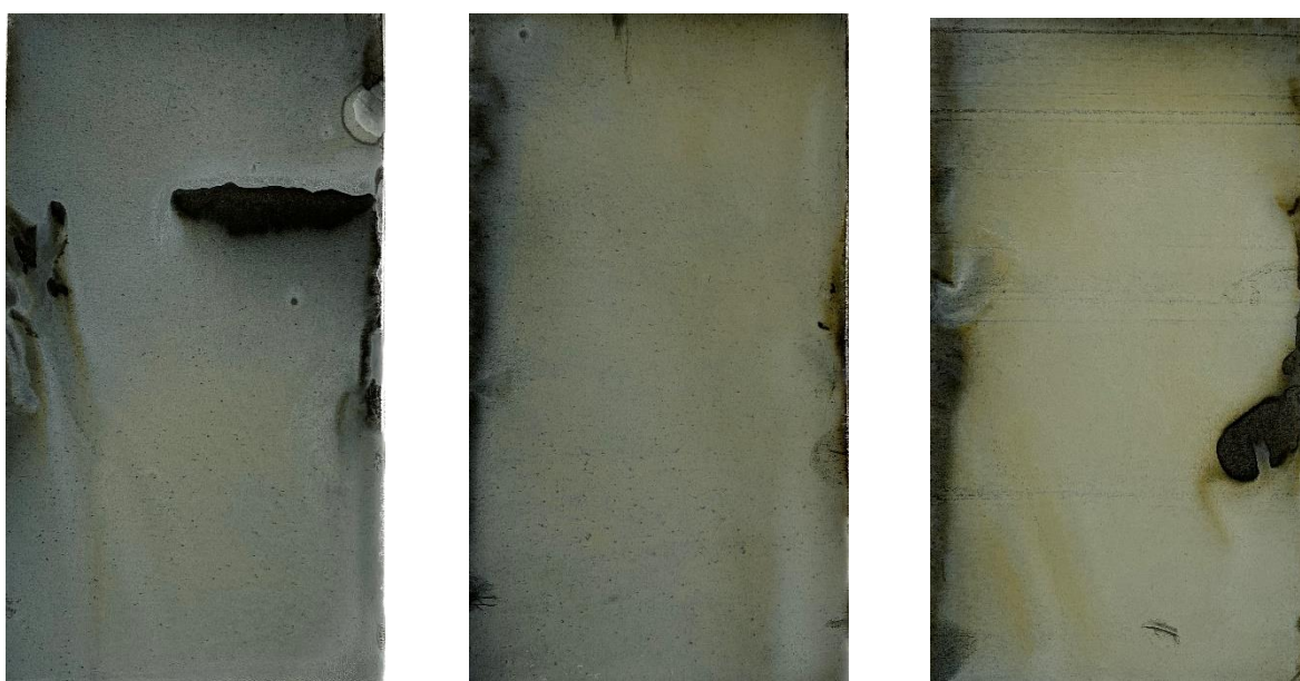
Obr. 38: Vzorky č. 19, 20 a 21 ponořeny do koncentrátu, umístěny do vnějšího prostředí Zdroj: (autor, 2023)
