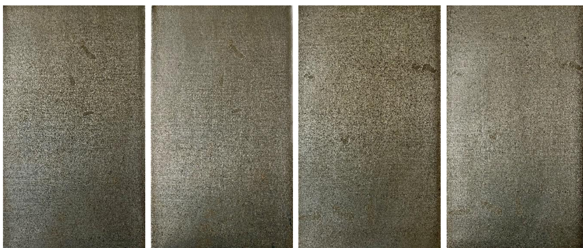
Obr. 51: Vzorek č. 1 (vlevo) a vzorek č. 2 (vpravo) po 12 hod a po 84 hodinách expozice Zdroj: (autor, 2023)
