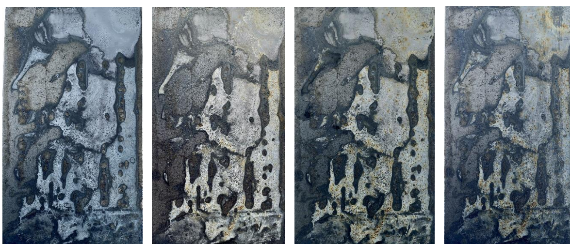
Obr. 68: Vzorek č. 24 po jednotlivých časových intervalech, tj. po 24, 60, 84 a 108 hodinách expozice Zdroj: (autor, 2023)
