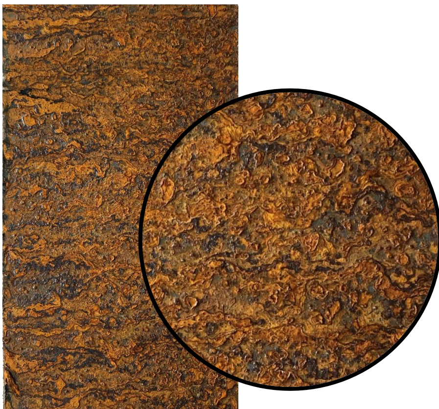
Obr. 74: Vzorek č. 27 včetně zvětšení po zkoušce NSS, expozice 48 hod
