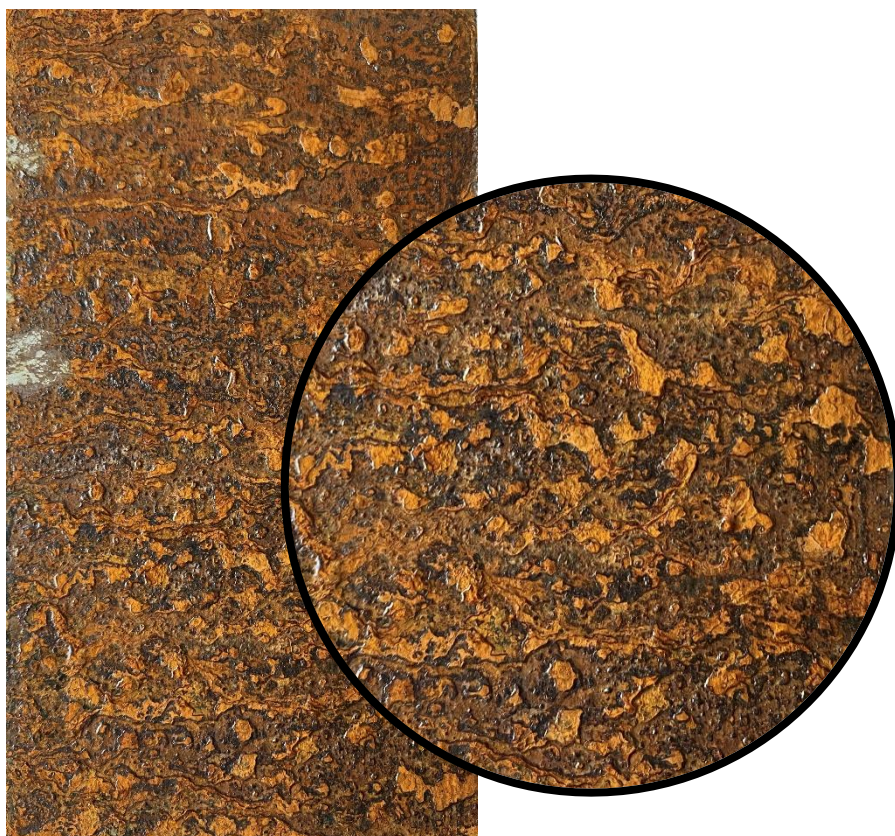
Obr. 82: Vzorek č. 28 včetně zvětšení po zkoušce NSS, expozice 48 hod
