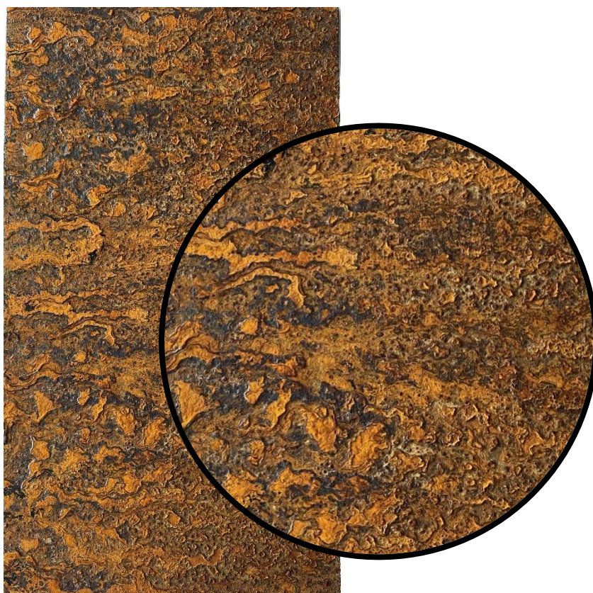
Obr. 77: Vzorek č. 30 včetně zvětšení po zkoušce NSS, expozice 48 hod
