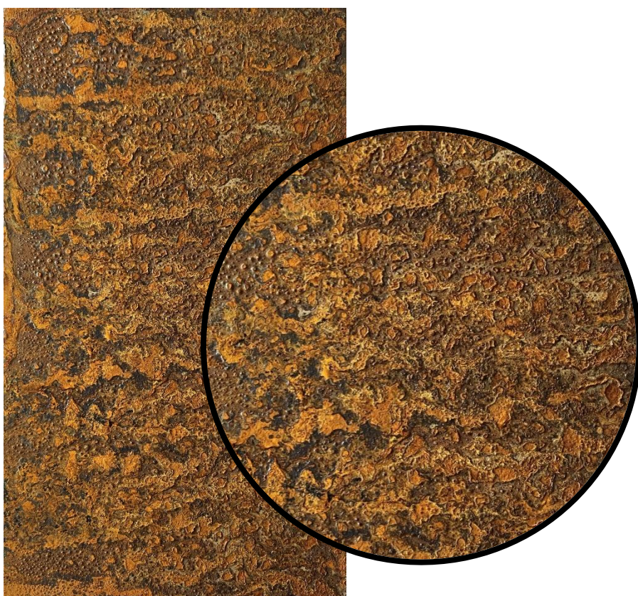
Obr. 79: Vzorek č. 32 včetně zvětšení po zkoušce NSS, expozice 48 hod
