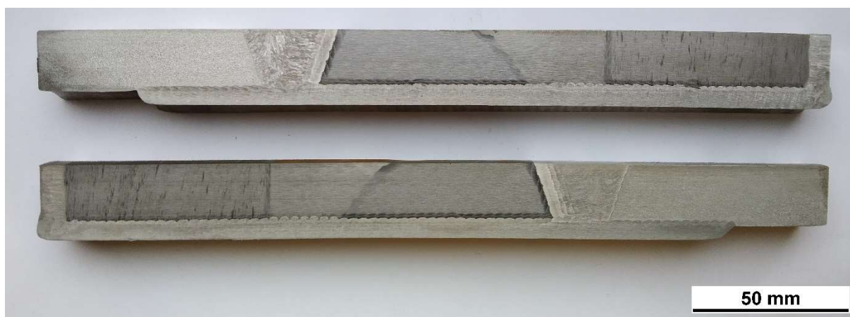
Obrázek 8-53 Makrostruktura zkušebního svarového spoje
