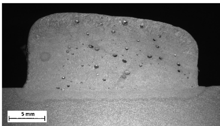
Obrázek 8-3 Pórovitost v návaru přídatným materiálem Sv-08G2S
