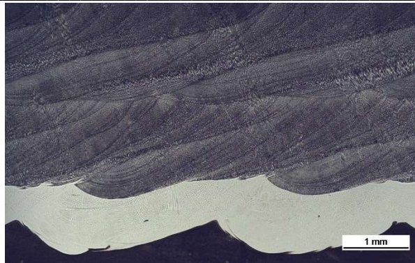
Obrázek 8-13 První tři vrstvy návaru na těleso H7
