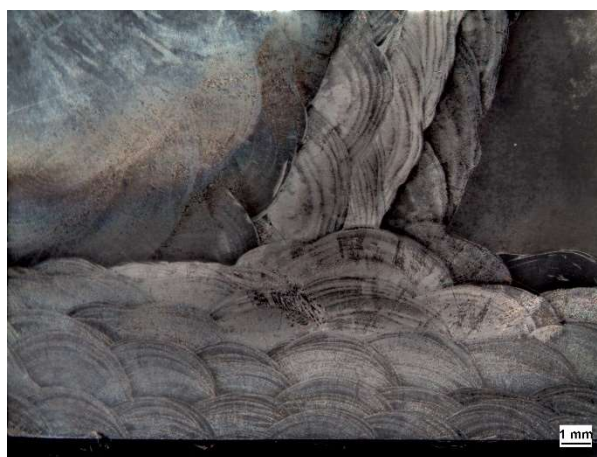
Obrázek 8-8 Oblast heterogenního svarového spoje oceli 08Ch18N10T (vlevo) a 22K (vpravo) s návarem č. 60 ve spodní části
