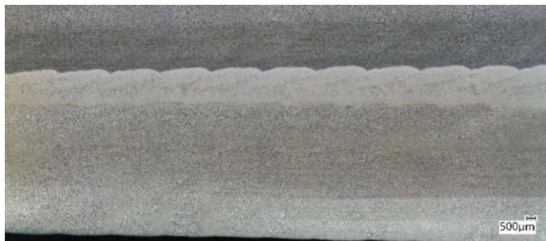
Obrázek 8-9 Návar přídavným materiálem ESAB OK Autrod 309LSi (dole) na tělese H0
