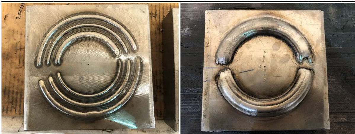
Obrázek 7-3 Dokončené navařování experimentálních návarů na deskách B a C
