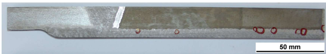
Obrázek 8-4 Trhliny v první vrstvě návaru č. 60 přídavným materiálem Sv-07Ch25N13
