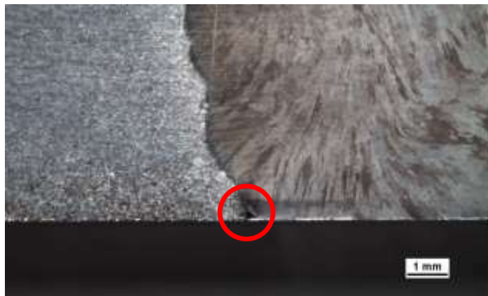
Obrázek 8-2 Vada typu studený spoj ve svarovém spoji č. 27
