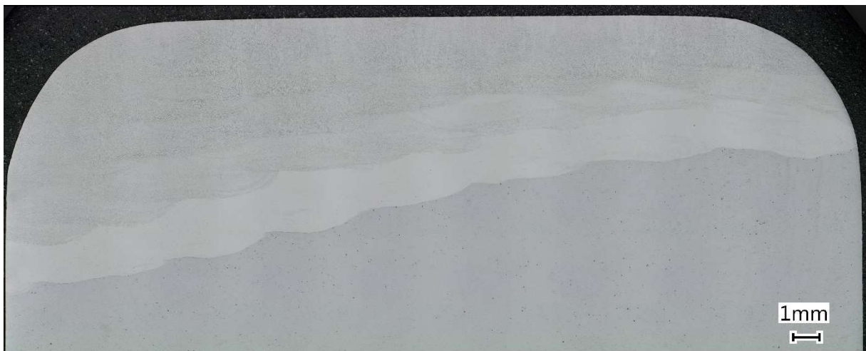
Obrázek 8-78 Návar Weld Overlay na základní materiál 22K přidavným materiálem Sv-07Ch25N13 průměr 1,0 mm
