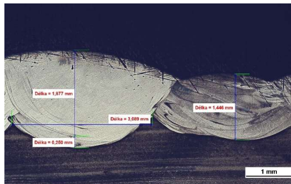
Obrázek 8-26 Oblast přechodu mezi jednovrstvým a dvouvrstvým návarem na těleso H12
