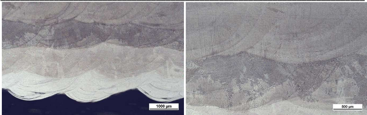
Obrázek 8-29 První čtyři vrstvy návaru na těleso H14A (vlevo) a přechod 3. a 4. vrstvy (vpravo)
