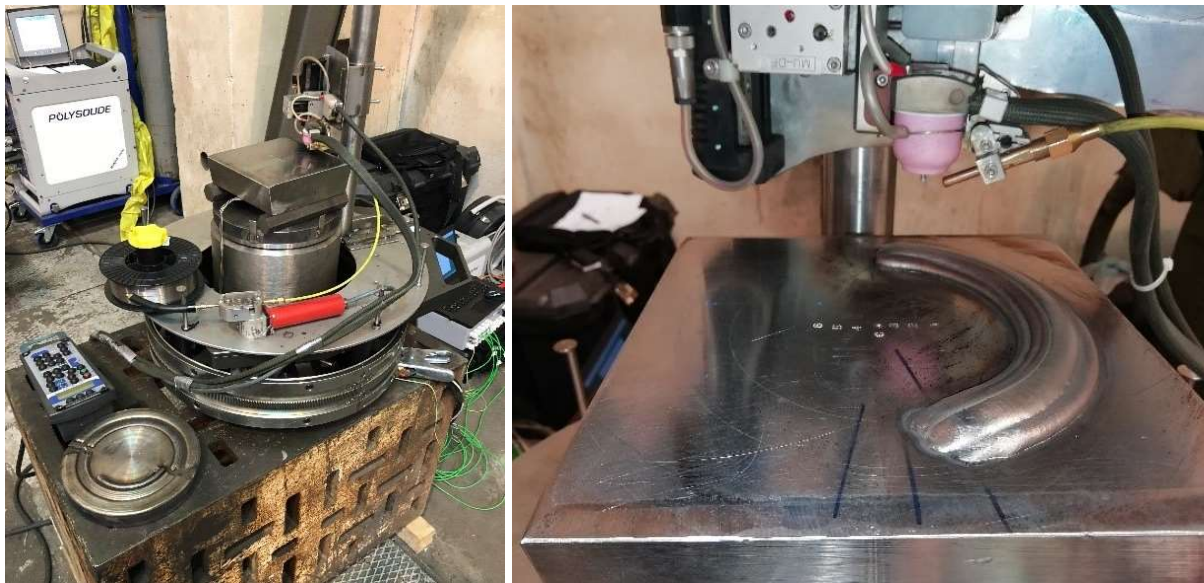
Obrázek 7-2 Průběh navařování experimentálních návarů na deskách
