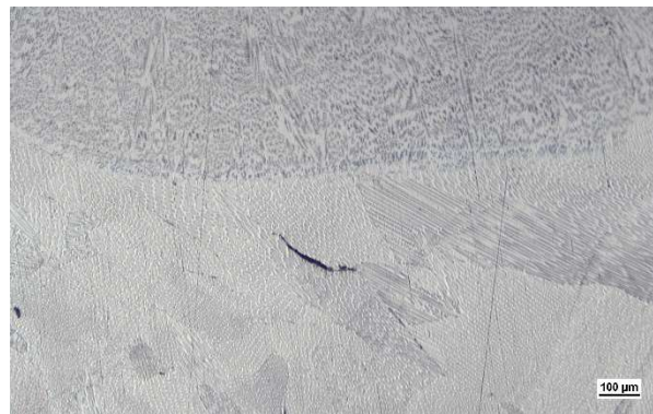
Obrázek 8-22 Trhlina v 1. vrstvě v tepelně ovlivněné oblasti od průchodu housenek 2. vrstvy návaru na tělese H10
