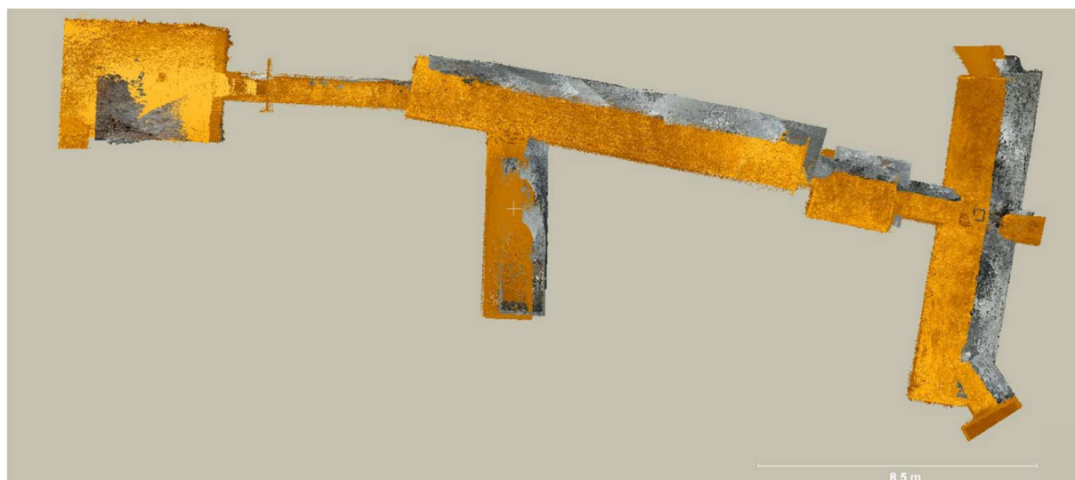
Obr. 56: Chyba v poloze georeferencovaného fotogrammetrického a laserskenového mračna bodů, orientováno na východ, vytvořeno v (EDF R&D 2022)
