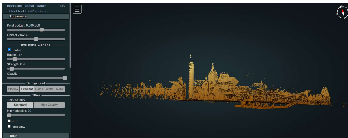
Obr. 59: Vizualizace celého mračna bodů pozemního mobilního laserového skenování
