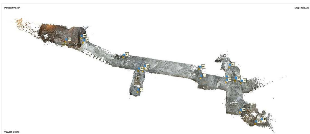
Obr. 50: Řídké mračno bodů s označenými markery, vytvořeno v (Agisoft LLC 2022b)
