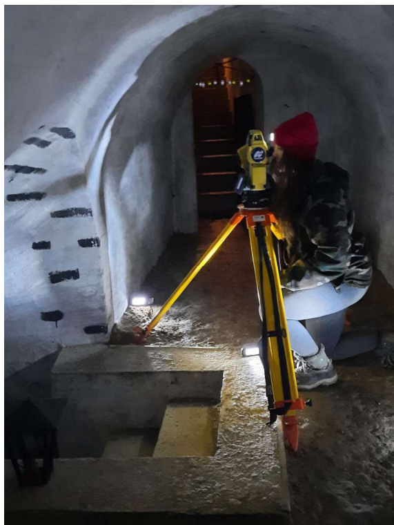
Obr. 26: Autorka předkládané diplomové práce při sběru prostorových dat v systému podzemních chodeb metodou tachymetrie s elektronickým dálkoměrem
