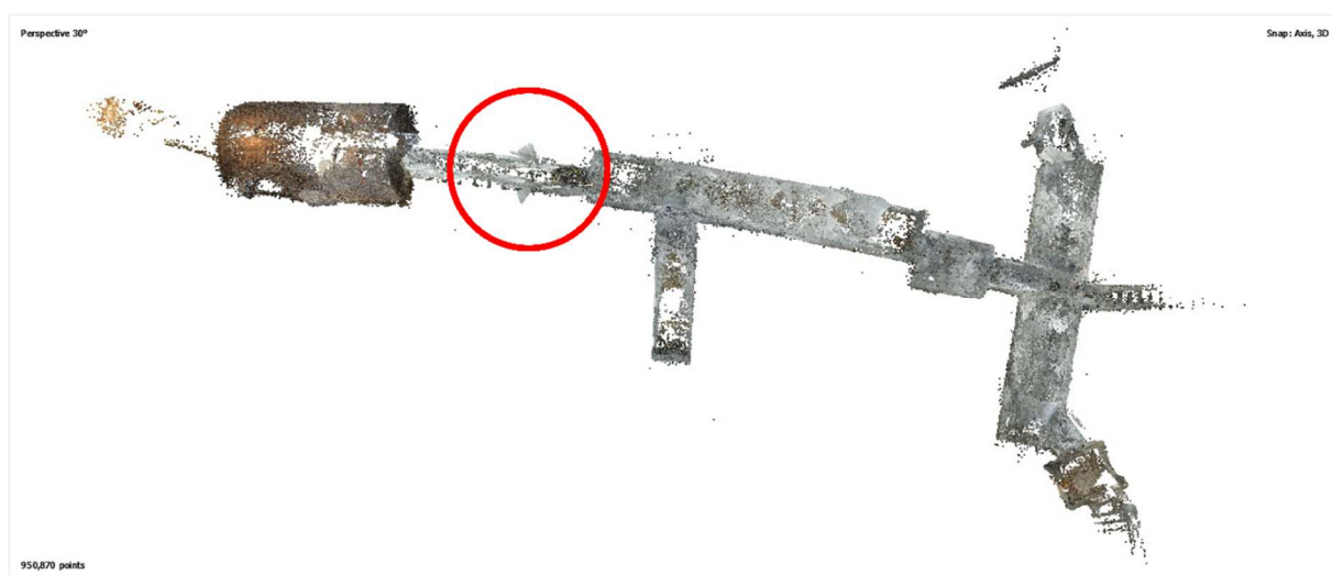
Obr. 48: Řídké mračno bodů, červeně označen příklad místa po chybném orientování snímků, vytvořeno v (Agisoft LLC 2022b)
