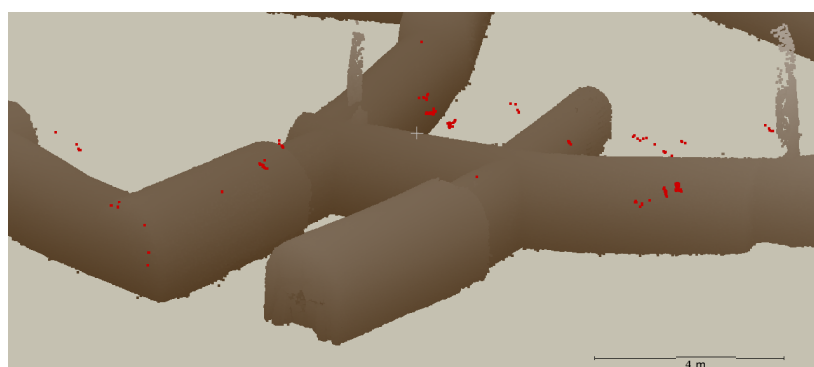
Obr. 36: Příklad odstraněných bodů funkcí Segment na mračnu bodů 2. části, vytvořeno v (EDF R&D 2022)
