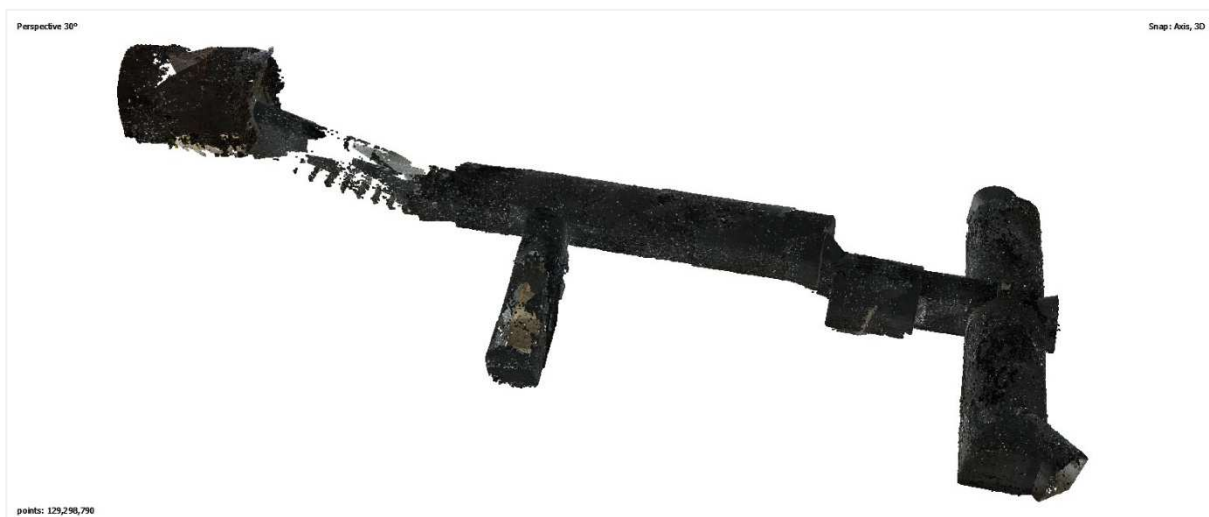
Obr. 54: Začištěné a oříznuté husté mračno bodů, vytvořeno v (Agisoft LLC 2022b)
