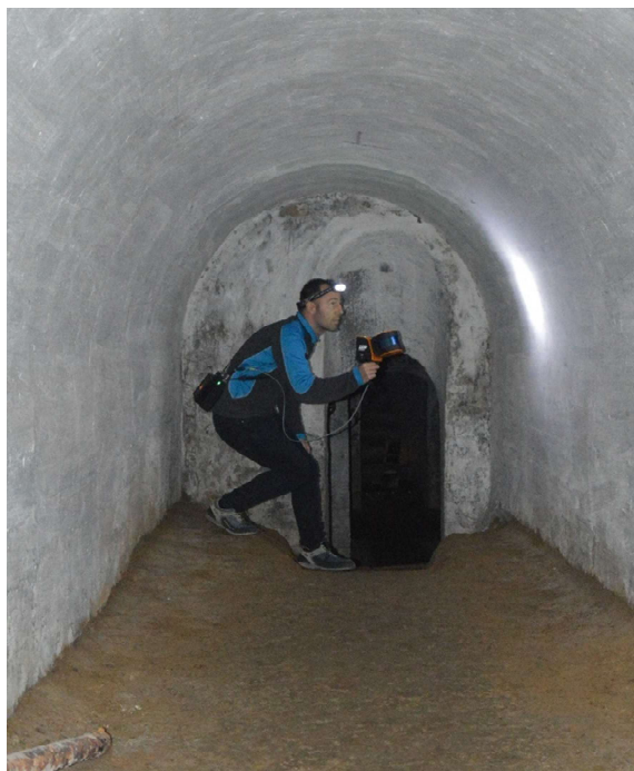
Obr. 22: Pan Ondřej Kříž při skenování systému podzemních chodeb (1)
