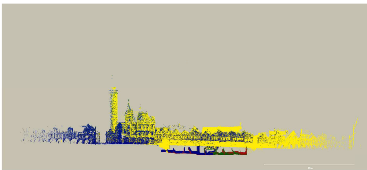
Obr. 37: Hrubě zarovnaná mračna bodů, pohled z boku, orientováno na sever, vytvořeno v (EDF R&D 2022)
