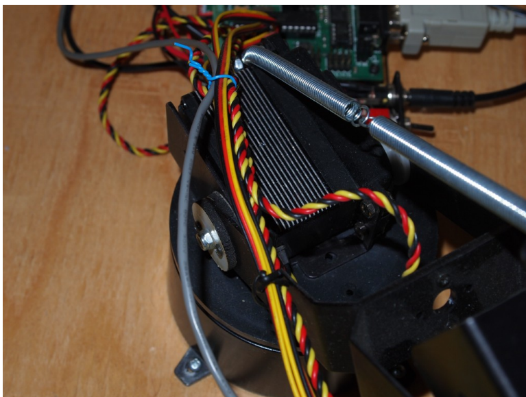
Obrázek 6 Správné vedení kabelů hlavního svazku
