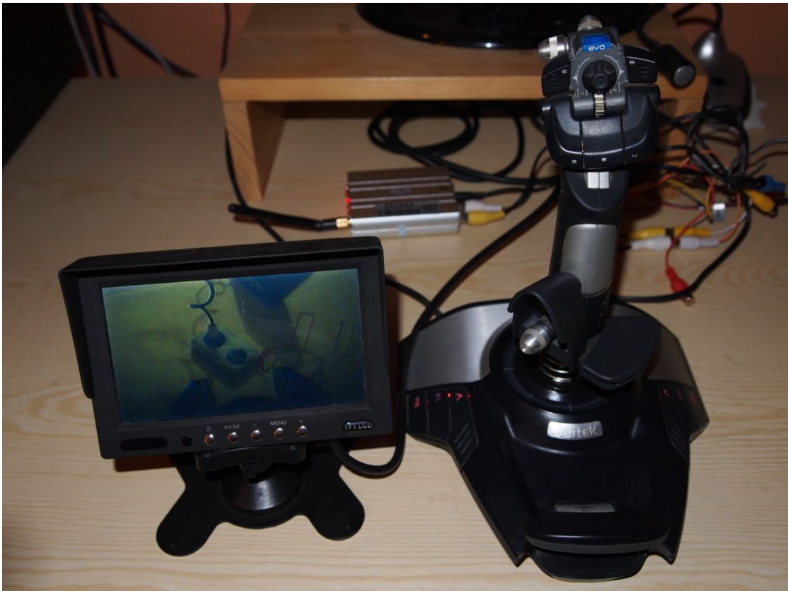
Obrázek 54 Sestava pro ovládání ruky pomocí bezdrátové kamery a joysticku
