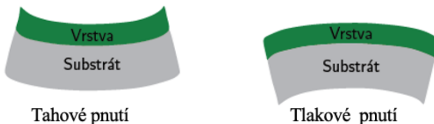
Obr. 8: Schématické znázornění působení pnutí na substrát - tahové pnutí (vlevo), tlakové pnutí (vpravo). Převzato z [10].
