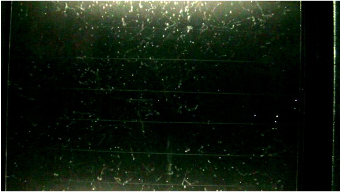
Obrázek 16 – Fotoelektrický jev a Comptonův rozptyl při umístění zářiče ^{241}\text{Am}
