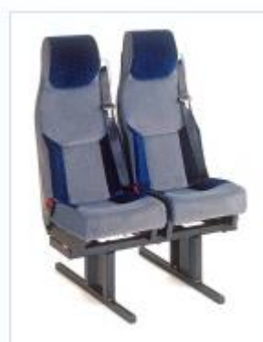
Obr. 6 Upevnění do podlahy [5]
