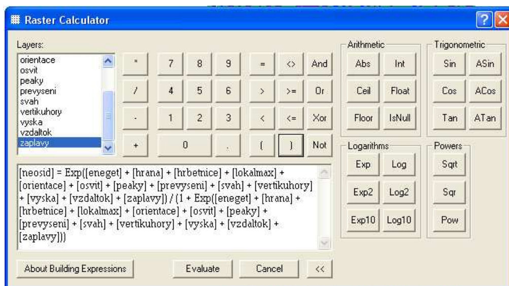
Obr. 28: ArcView nástroj „RASTER CALCULATOR“ s ukázkou vzorce pro výpočet predikční mapy
