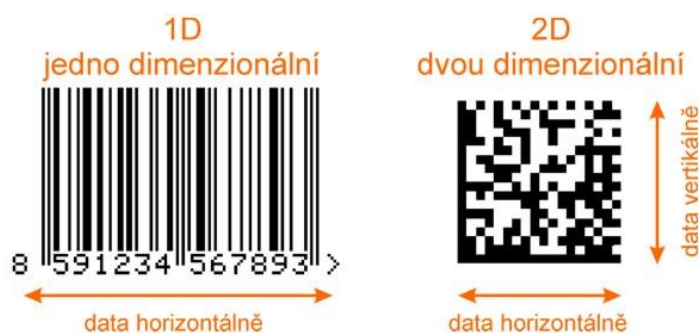
Obrázek 5 – jedno dimenzionální kód a dvou dimenzionální kód (Zdroj: Tiskovéhlavy.cz 2023)
