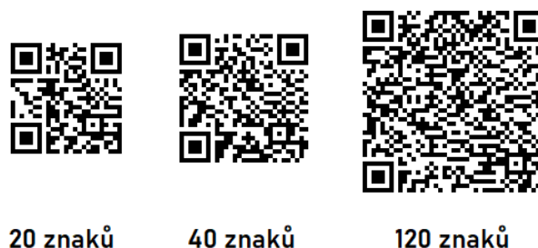
Obrázek 9 - Zhušřování matice QR kódu (Zdroj: vlastní)
