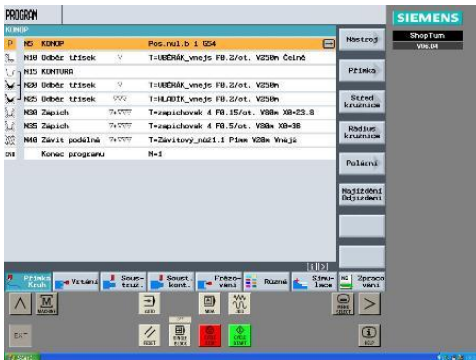
Obr. č. 14: Obrazovka ShopTurnu – zápis programových bloků
