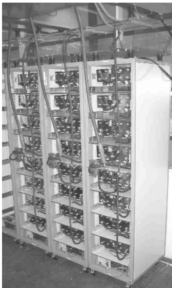
Obr. 2.6: Prototyp 17úrovňového (DC / 3f AC) MMLC měniče o výkonu 2 MW s konvenčními 1,2 kV IGBT chlazenými vzduchem. Obrázek převzat z [17].
