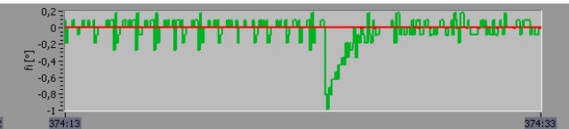
Obr. 7.18b: Průběh fáze při skokové změně napájecího napětí z U_{1ef} = 100 \text{ V} na U_{1ef} = 20 \text{ V} . L_f = 24 \text{ mH} , C_f = 30 \mu\text{F} , P(U_{1ef} = 20 \text{ V}) = 15 \text{ W} , P(U_{1ef} = 100 \text{ V}) = 350 \text{ W} .
