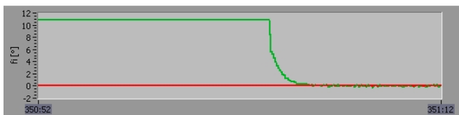
Obr. 7.17: Průběh fáze při zapnutí regulačního algoritmu řízení fáze vkládáním nulových vektorů. L_f = 24 \text{ mH} , C_f = 30 \mu\text{F} , P = 350 \text{ W} .
