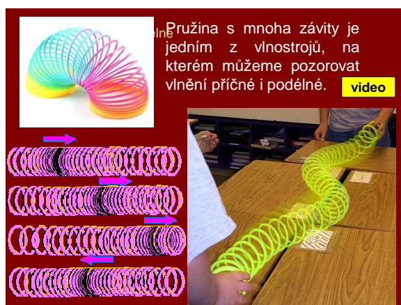
Obr. 3.5.1. slinky [20], Obr. 3.5.2. podélné vlnění [21], Obr. 3.5.3. příčné vlnění [22]
