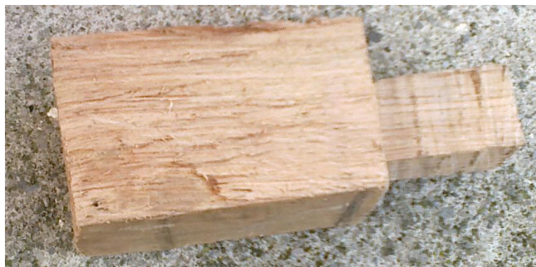
Obrázek 11 – Výroba kolíku hoblíku
