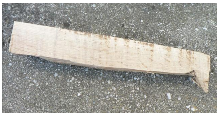
Obrázek 10 – Výroba klínu hoblíku
