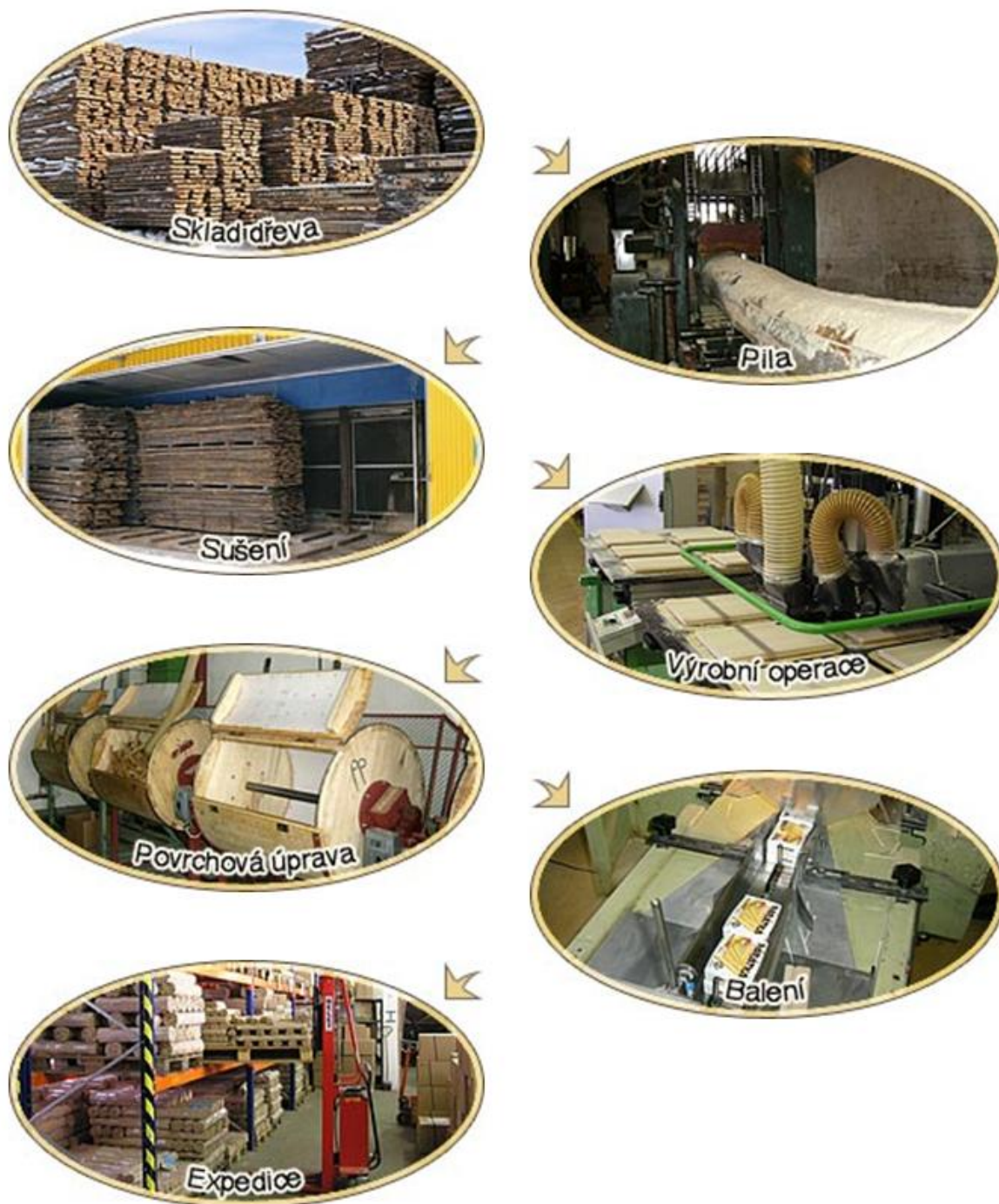
Obrázek 27 – Technologie výroby párátek (5)
