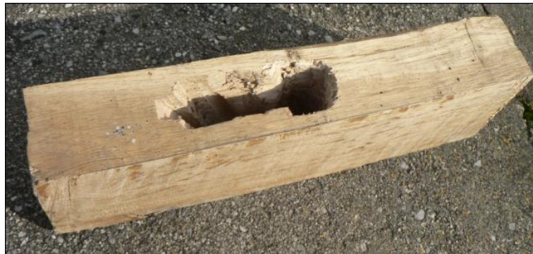
Obrázek 9 – Výroba těla hoblíku
