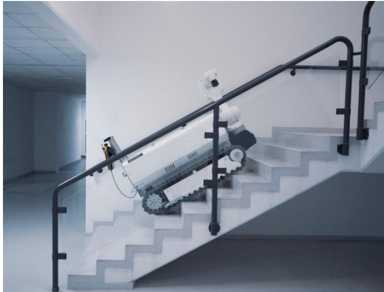
Obrázek 23: Robot Baubot MRS12 při zdolávání překážek
