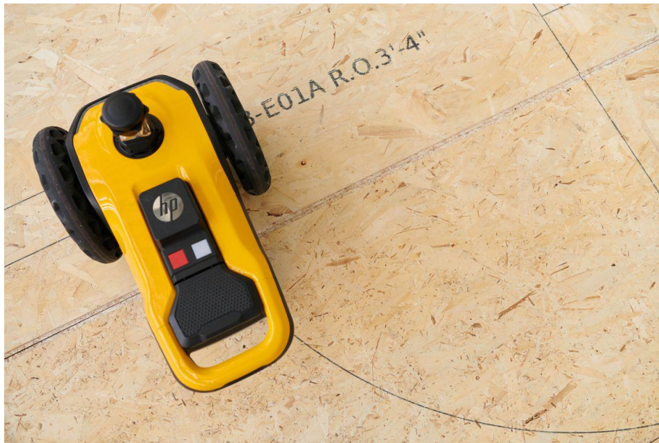
Obrázek 20: Robotická tiskárna SitePrint od společnosti Hewlett-Packard Development Company, LP
