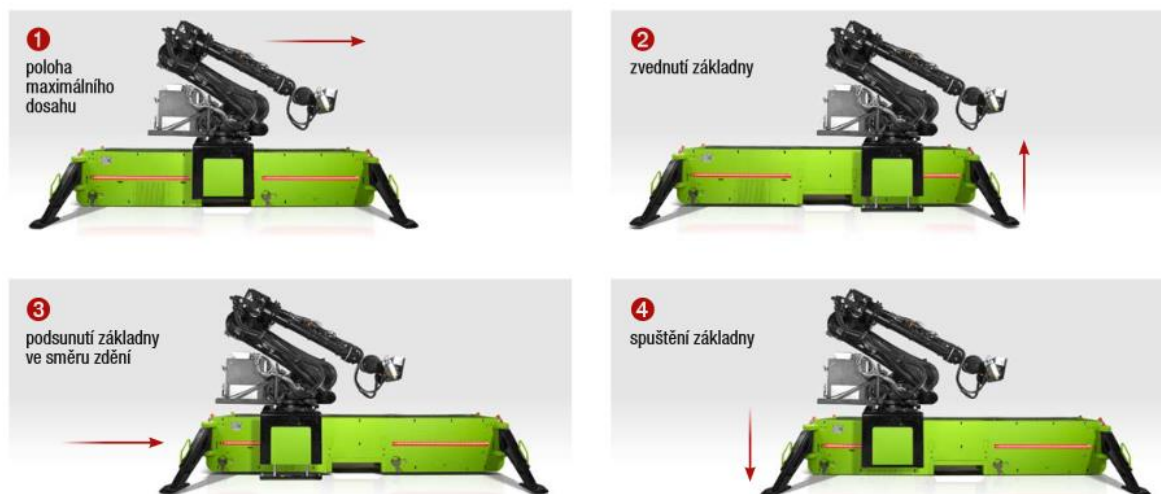
Obrázek 9: Autonomní pohyb zdícího robota Wienerberger podél vyzdívané stěny
