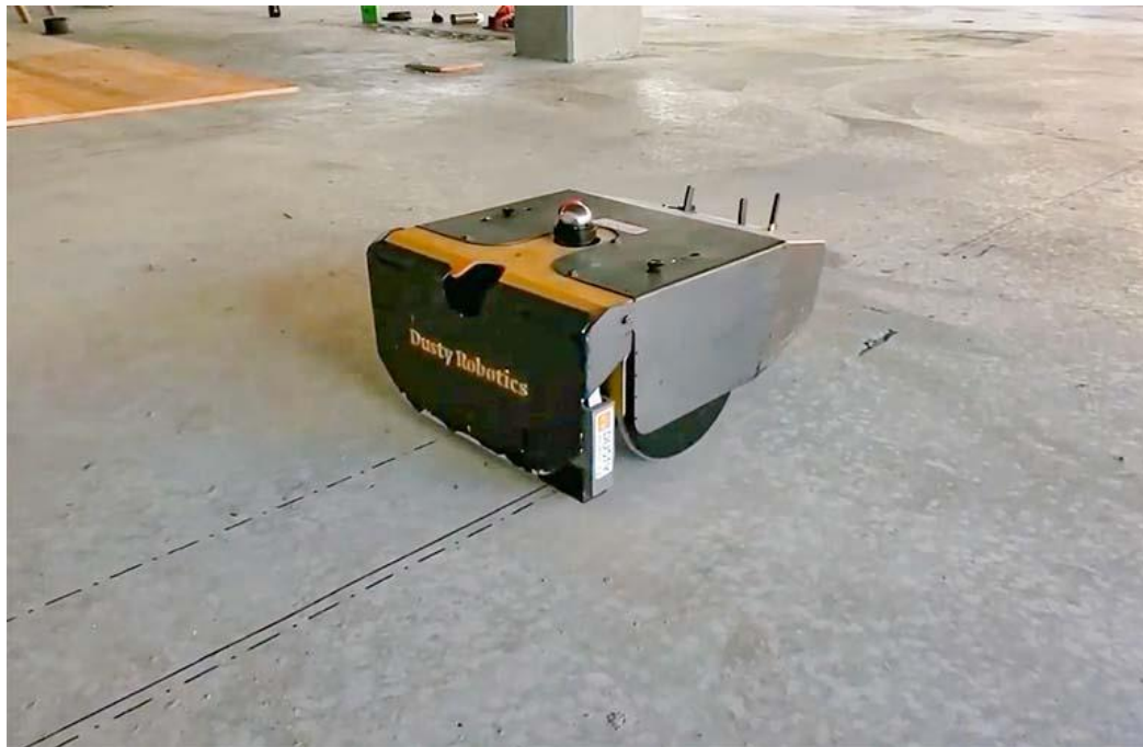
Obrázek 19: Autonomní mobilní tiskařský robot FieldPrinter od společnosti Dusty Robotics
