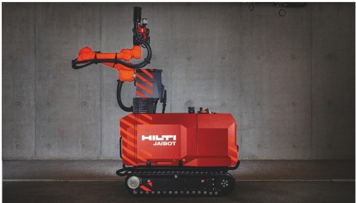
Obrázek 21: Poloautonomní vrtací robot Jaibot od společnosti Hilti AG
