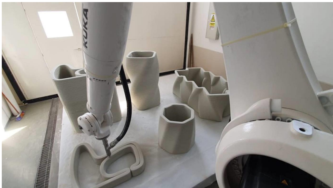
Obrázek 16: Robot KR Quantec je schopný za pomoci 3D tisku vytvořit produkty jakýkoliv tvarů
